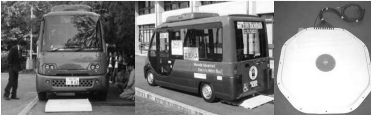
σχήμα 2.1 : Εγκατεστημένο σύστημα και δευτερεύον μετασχηματιστή [3]
