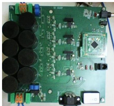
σχήμα 4.13 : Αντιστροφέας ισχύος εργαστηρίου ηλεκτρονικών ισχύος
