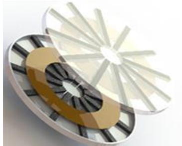
σχήμα 1.4 : Μοντέλο πηνίων που δημιουργούν έναν φορτιστή
