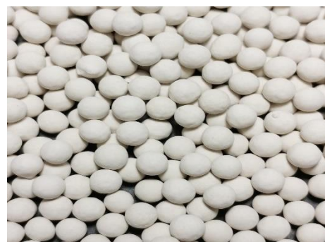
Εικόνα 8: Μοριακά κόσκινα τύπου 3A που χρησιμοποιούνται για τον διαχωρισμό του μίγματος αιθανόλη-νερό. [39]
