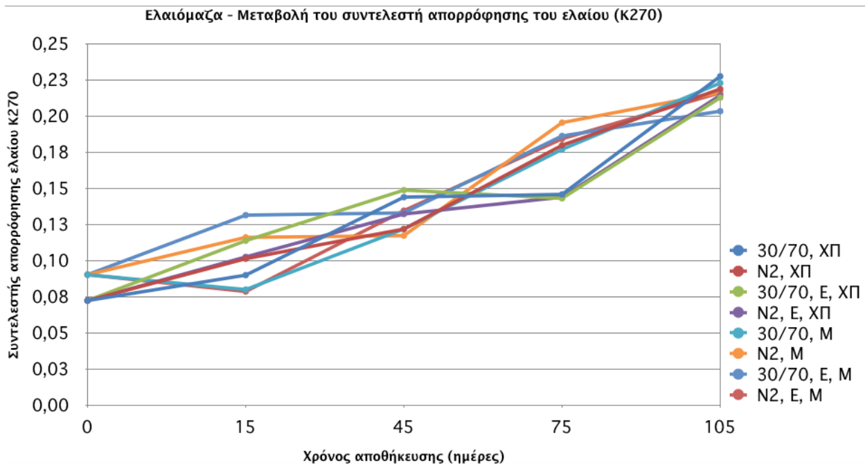
Διάγραμμα 11: Μεταβολή του συντελεστή απορρόφησης ελαιόλαδου K_{270} του εξαγόμενου ελαιόλαδου συναρτήσει του χρόνου αποθήκευσης για επεξεργασμένη ή μη ελαιόμαζα ( T=25^{\circ}\text{C} )
