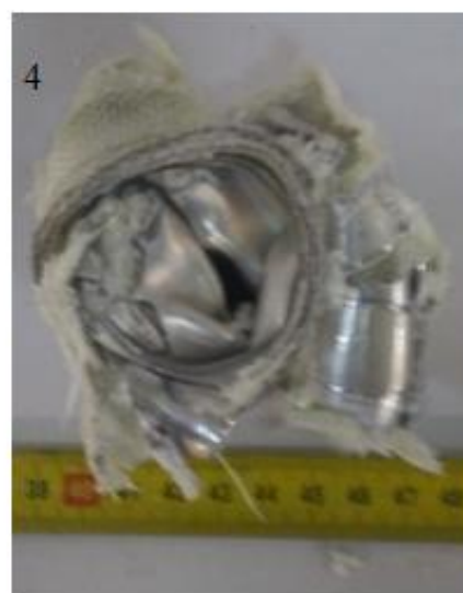
Εικόνες 4.29.1-4.29.4: Υβριδικό δοκίμιο κοίλης κυλινδρικής γεωμετρίας μετά από αξονική συμπίεση. Οί φωτογραφίες 1,2 απεικονίζουν την πρόσοψη του δοκιμίου. Η φωτογραφία 3 την κάτοψη από την πλευρά επαφής με το κινούμενο εμβολο συμπίεσης . Στην φωτογραφία 4 παρουσιάζεται η κάτοψη του δοκιμίου που βρισκόταν σε επαφή με την σταθερή πλάκα της διάταξης θλίψης.
