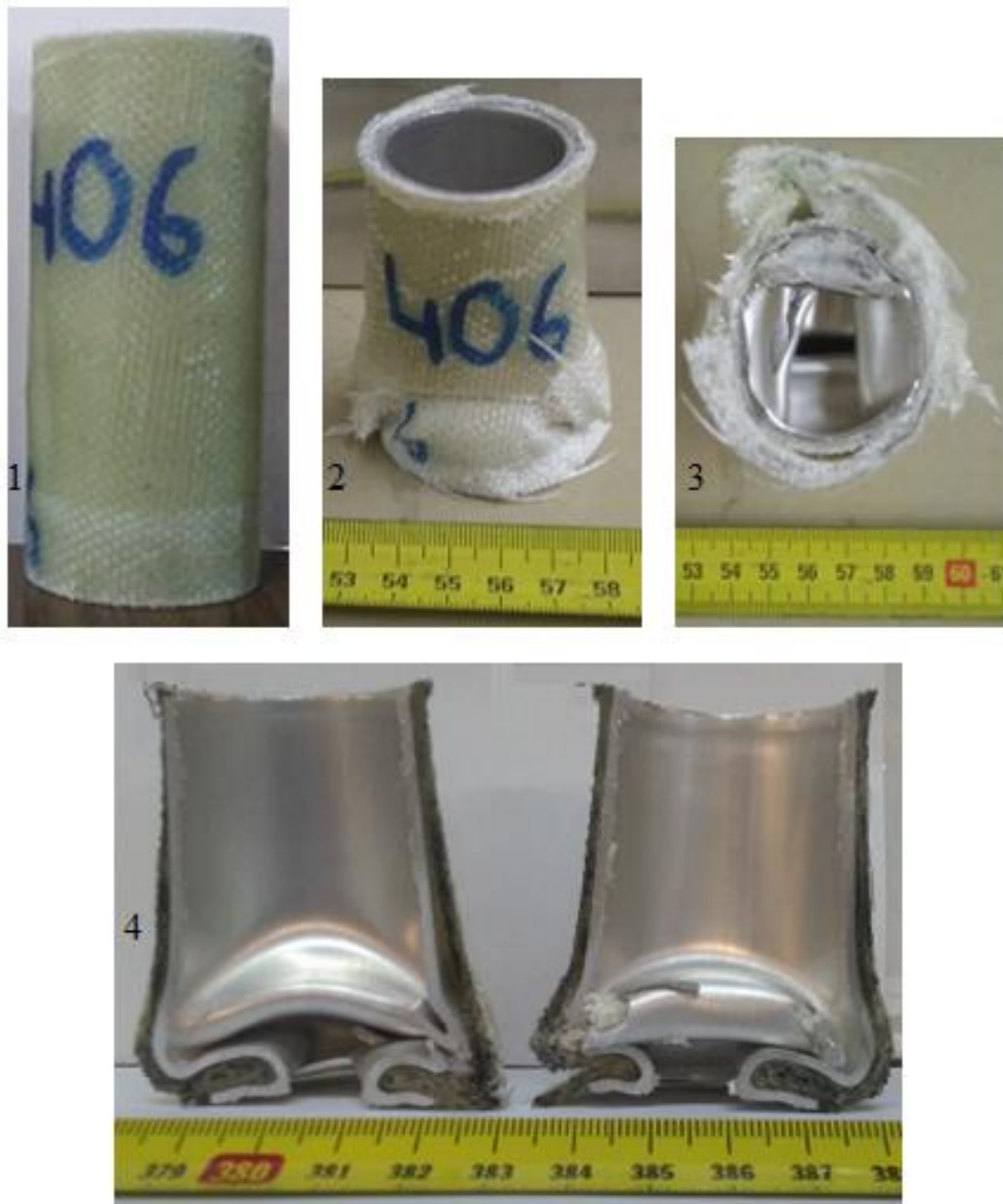
Εικόνες 4.30.1-4.30.4: Υβριδικό δοκίμιο κοίλης κυλινδρικής γεωμετρίας. Στην εικόνα 1 παρατίθεται το δοκίμιο πριν του ασκηθεί μηχανικό φορτίο μέσω της σφύρας. Στην εικόνα 2 παρουσιάζεται όψη του δοκιμίου μετά από την άσκηση κρουστικού φορτίου. Η εικόνα 3 παρουσιάζει την κάτοψη του συντεθλιμμένου δοκιμίου από την πλευρά επαφής με την ακίνητη πλάκα έδρασης. Η εικόνα 4 αποτελεί την τομή του δοκιμίου.
