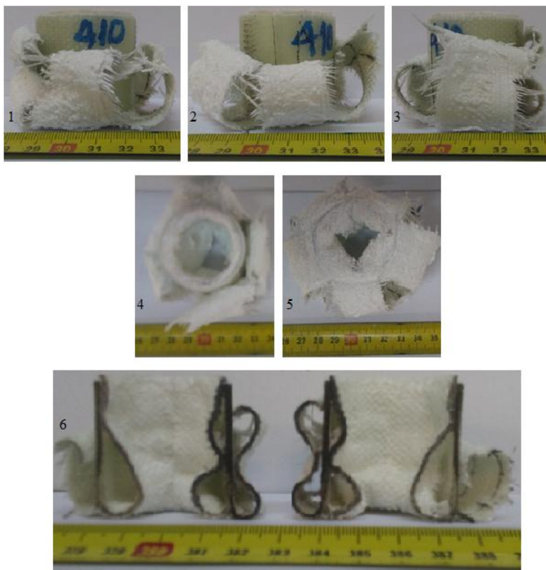
Εικ.4.16.1-4.16.6: Τελικές όψεις δοκ.410 (μετά την αξονική συμπίεση και κατάρρευση). Οι φωτογραφίες 1-3 απεικονίζουν πλευρικές όψεις. Η φωτογραφία 4, την κάτοψη από την πλευρά άσκησης φορτίου μέσω του κινούμενου εμβόλου, ενώ η φωτογραφία 5 την κάτοψη από την πλευρά της σταθερής πλάκας. Στη φωτογραφία 6 παρουσιάζεται η τομή του συντεθλιμμένου δοκιμίου.
