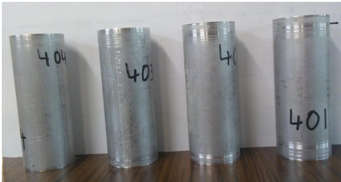
Εικόνα 3.1: Κοίλα κυλινδρικά δοκίμια βιομηχανικής παραγωγής με εμφανή τα σημάδια τόννευσης στα κατεργασμένα άκρα.
