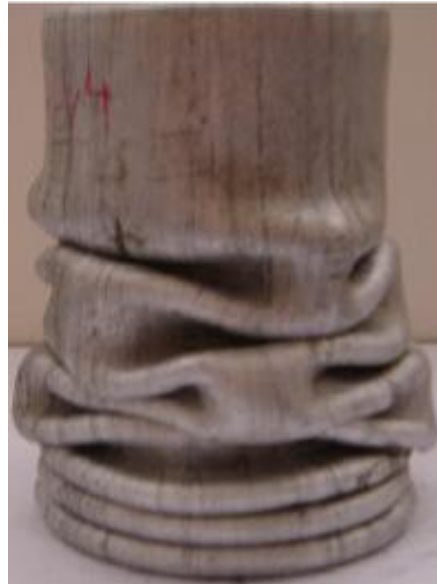
Εικόνα 1.9: Μικτός τρόπος κατάρρευσης δοκιμίου
