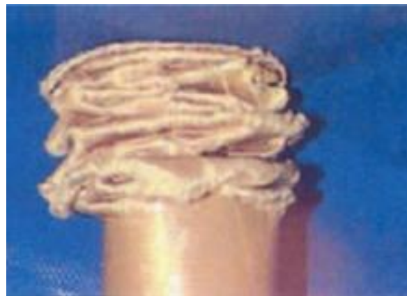
Εικόνα 1.4: Απεικόνιση σύνθετου δοκιμίου που έχει καταρρεύσει με progressive folding τρόπο.
