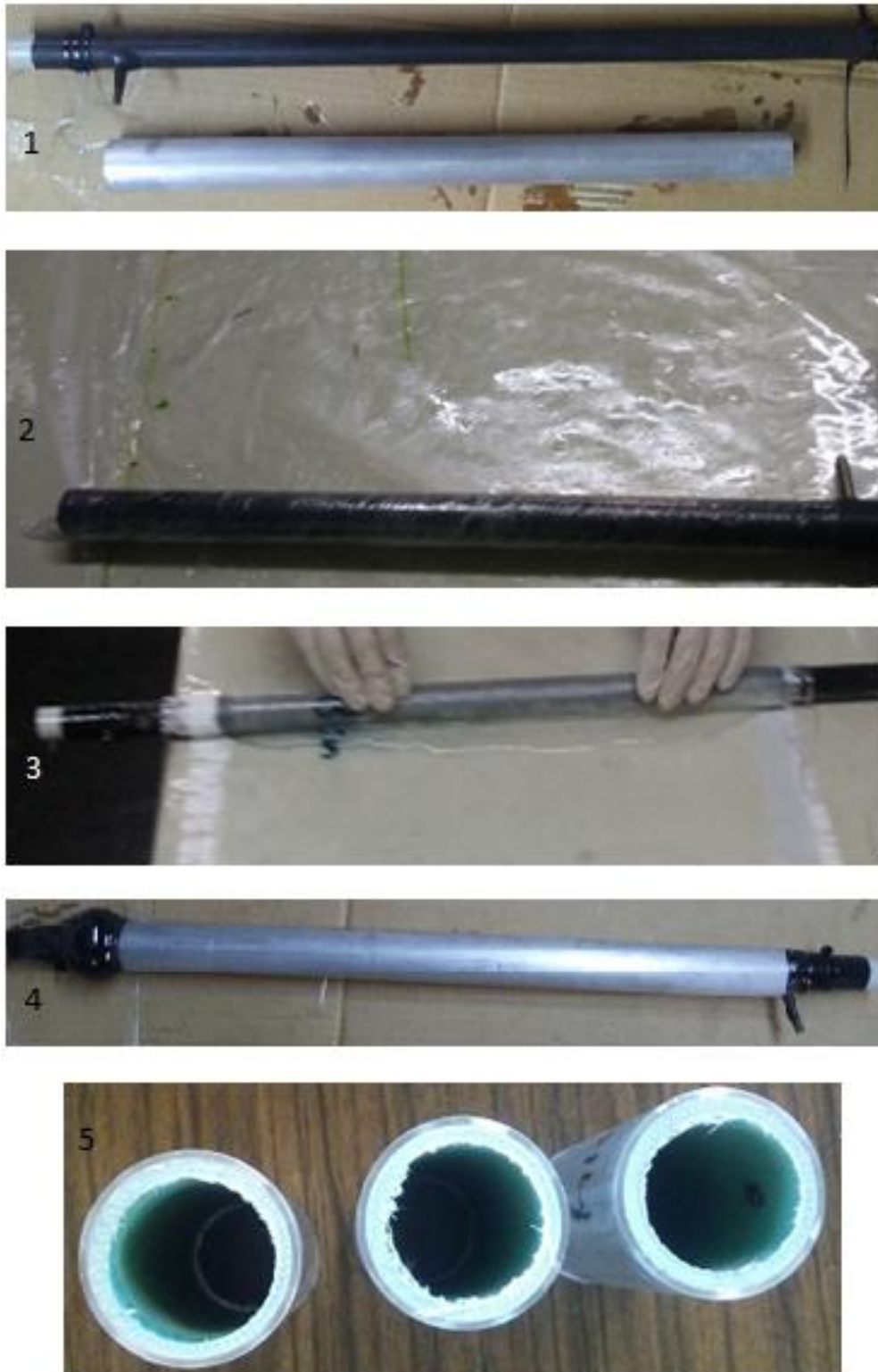
Εικόνα 3.4: Συνοπτική παρουσίαση της παραγωγής υβριδικών δοκιμίων (AI-out).
