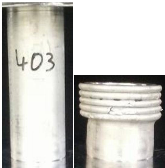
Εικόνα 1.7: Αξονοσυμμετρικός τρόπος κατάρρευσης. Παρουσιάζεται η δομή του δοκιμίου πριν και μετά την επιβολή θλιπτικού φορτίου.
