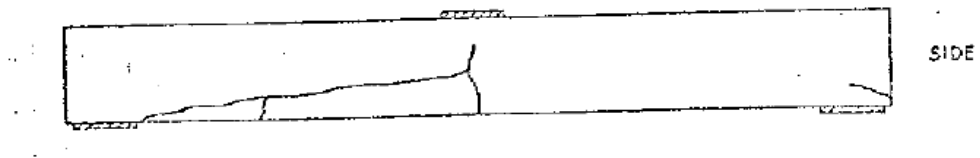
Εικ. 6.13(α): Σκαρίφημα αστοχίας δοκού Sterling (αρχική προφόρτιση 500 psi)
