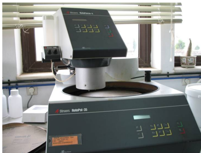
Σχήμα 3.4: Συσκευή λείανσης STRUERS RotoPol - 35 με εφαρμοσμένη κεφαλή STRUERS RotoForce - 4.
