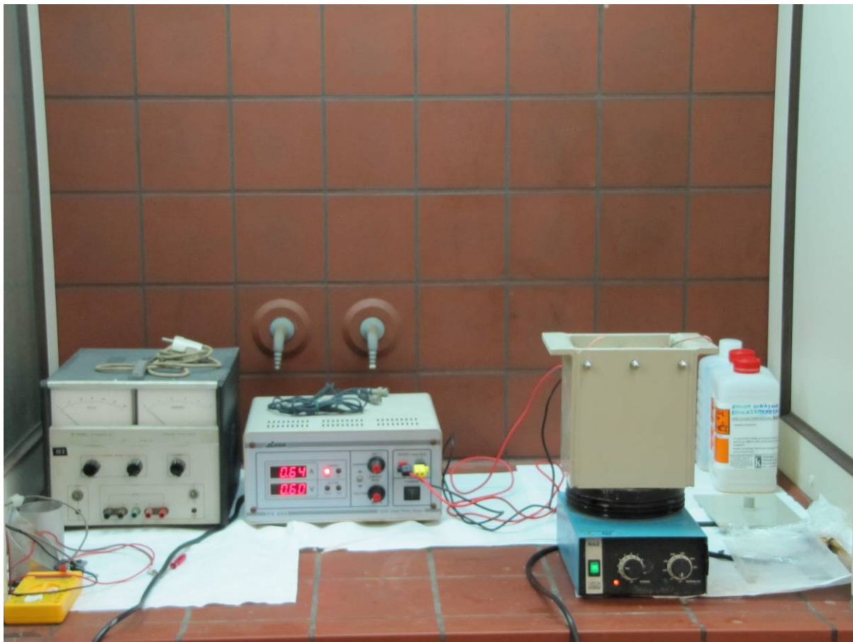
Σχήμα 3.11: Απεικόνιση της διάταξης που χρησιμοποιήθηκε για την παρασκευή των απλών επικαλύψεων κασσιτέρου στα ορειχάλκινα δοκίμια εφελκυσμού και κρούσης.
