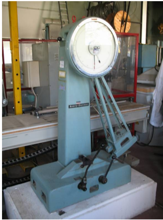
Σχήμα 3.24: Μηχάνη κρούσης Avery Denison (300 J) του Εργαστηρίου Αντοχής Υλικών του Κ.Α.Ε.Π.
