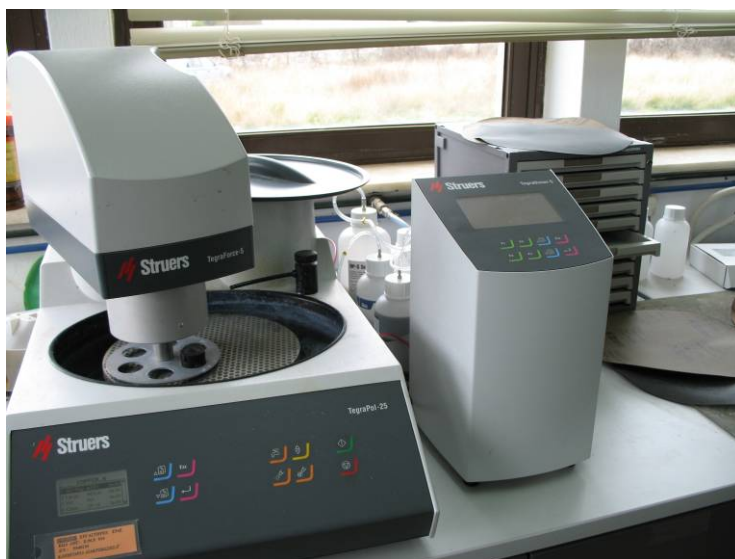
Σχήμα 3.2: Συσκευή αυτόματης λείανσης - στίλβωσης δοκιμίων STRUERS TegraPol - 25 με τα παρελκόμενα STRUERS TegraForce - 5 και TegraDoser - 5.
