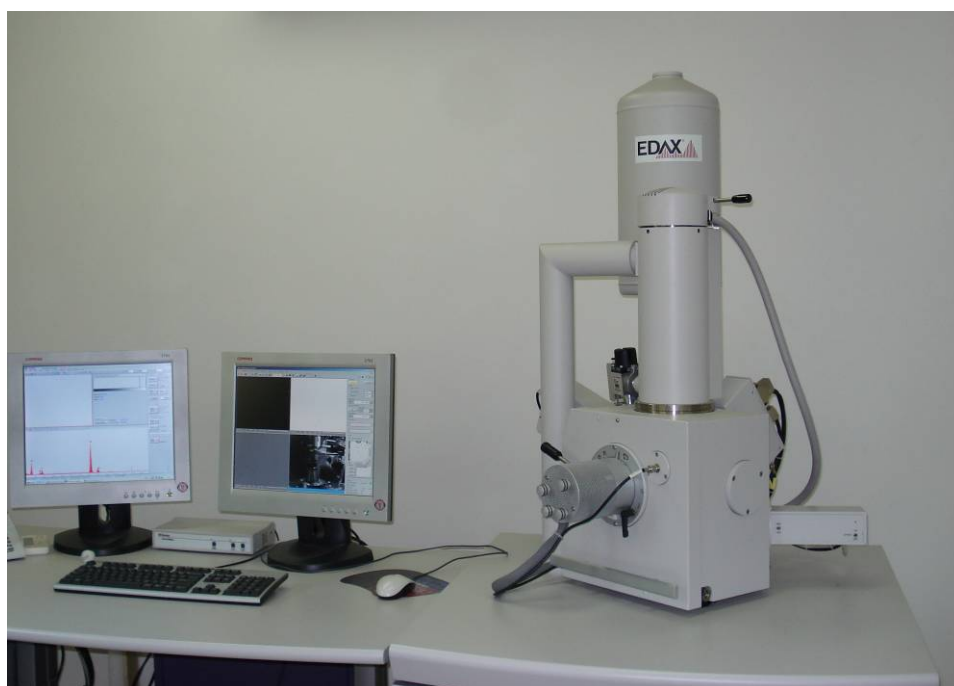
Σχήμα 3.15: Το S.E.M. της εταιρείας FEI - QUANTA 200 με σύστημα μικροανάλυσης EDAX, της Σχολής Χημικών Μηχανικών του Ε.Μ.Π.
