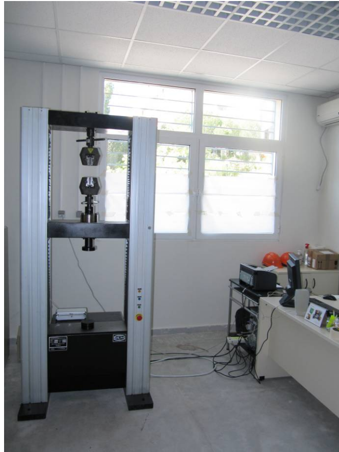
Σχήμα 3.19: Μηχανή εφελκυσμού WDW-50E, μέγιστου φορτίου 50 kN, της εταιρείας TIME GROUP INC., του Εργαστηρίου Τεχνολογίας Κονιαμάτων της Σχολής Χημικών Μηχανικών του Ε.Μ.Π.
