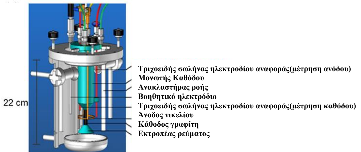
Σχήμα 1.9: Πειραματική διάταξη ηλεκτρολυτικού κελιού ULCOWIN [24]
