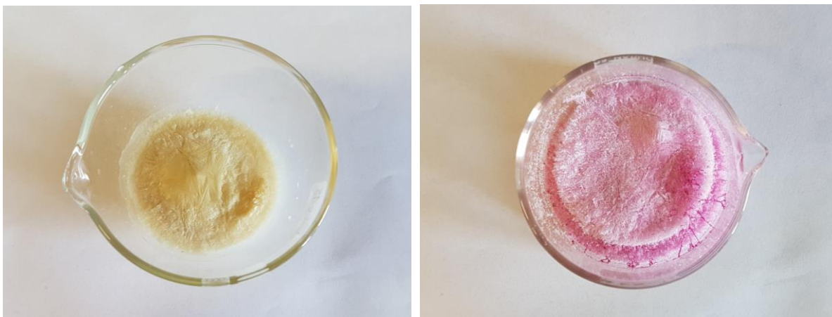
Εικόνα 17: Δείγματα εγκλεισμού με την τροποποιημένη μέθοδο λυοφιλοποίησης. KTZ15 (αριστερά) και KTZ14 (δεξιά).
