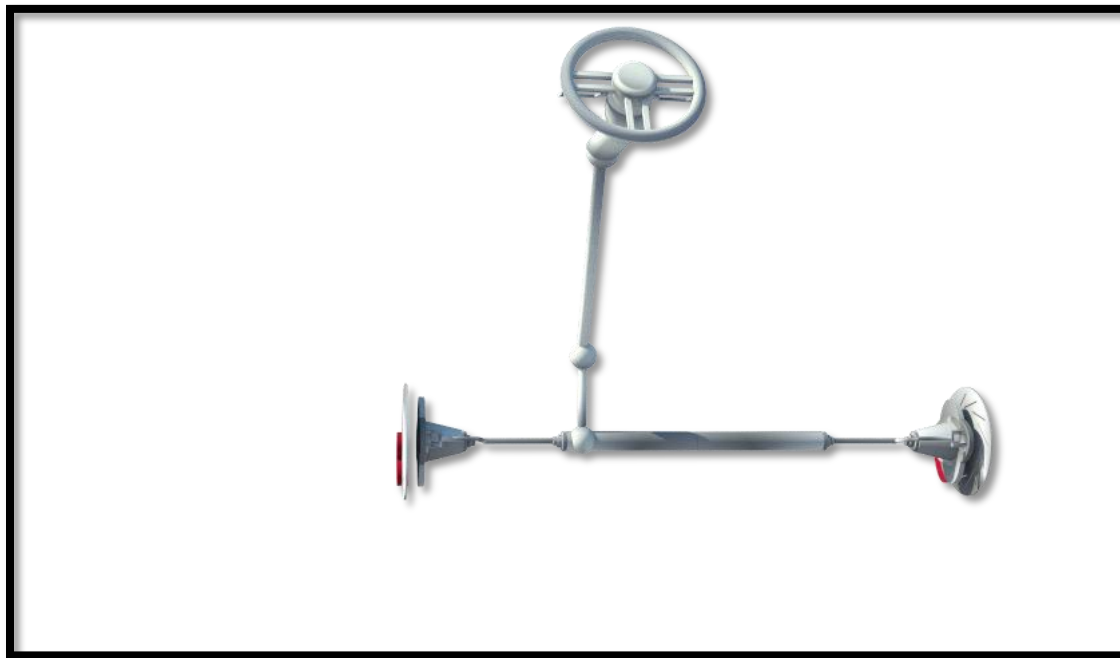
Σχήμα 5.15: Σύστημα διεύθυνσης (β)
