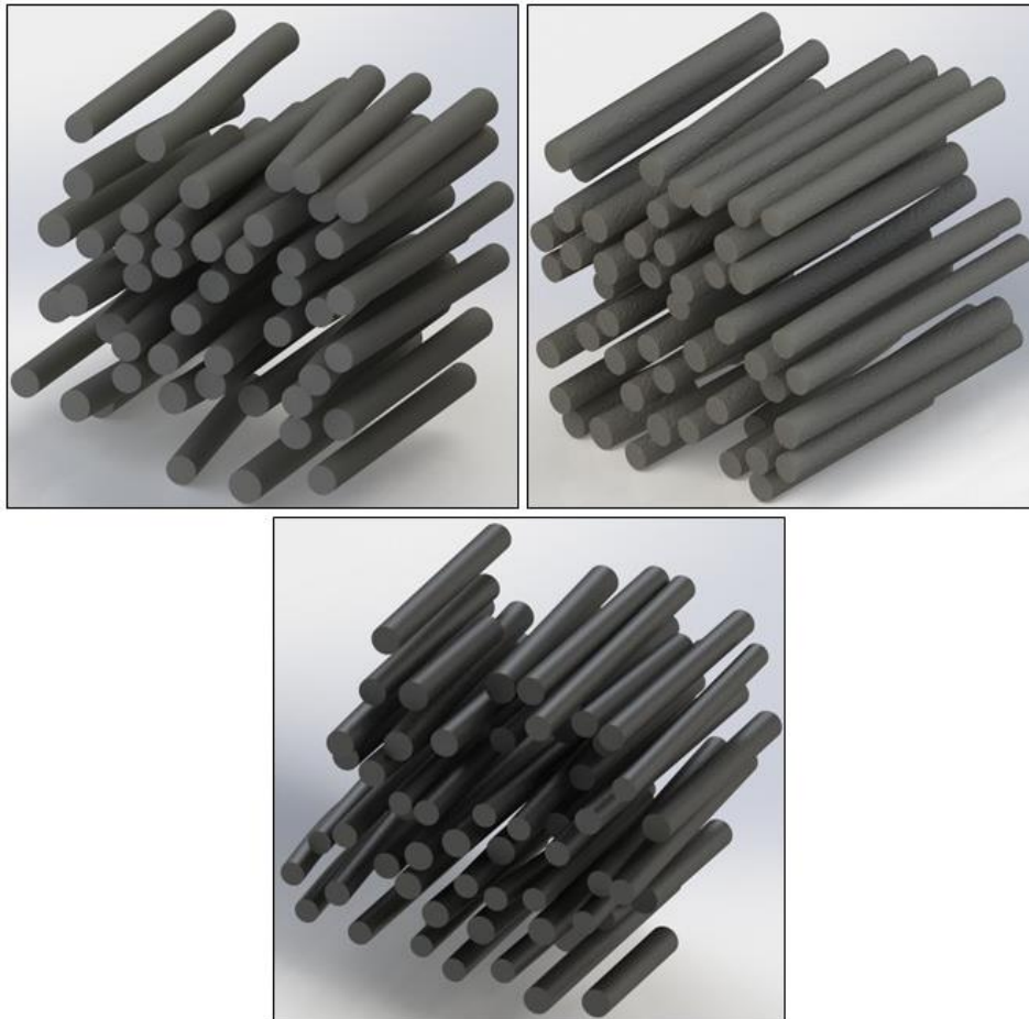
Εικόνα 4.15: Επανασχηματισμός των ινών άνθρακα και των τριών αρχείων STL.
