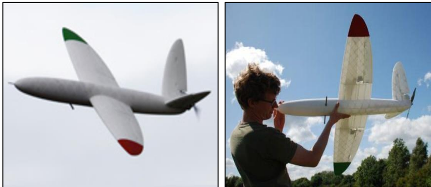
Εικόνα 3.2: Πρώτο μη επανδρωμένο 3-D αεροσκάφος {7, 8}.
