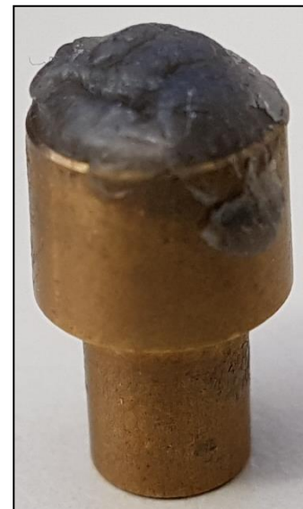
Εικόνα 4.2: Δειγματοφορέας, με ποσότητα κεριού πριν την τοποθέτηση του δείγματος προς σάρωση.
