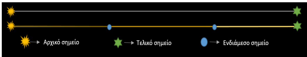
Εικόνα 4.39: Διαφορετικοί τρόποι κίνησης της κεφαλής για την ίδια διαδρομή κατά την εκτύπωση. Στην πάνω γραμμή η κεφαλή έχει ένα αρχικό και ένα τελικό σημείο ενώ η κάτω διαδρομή για την ίδια απόσταση χωρίζεται σε τρεις μικρές διαδρομές.
