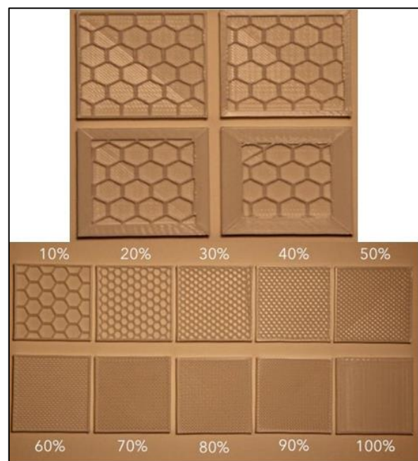
Εικόνα 3.18: Στην πάνω εικόνα παρουσιάζεται η κατασκευή του αντικειμένου με 2, 5, 10 και 15 κελύφη, αντίστοιχα, ενώ στην κάτω παρουσιάζονται περιπτώσεις διαφορετικού ποσοστού πλήρωσης {28}.
