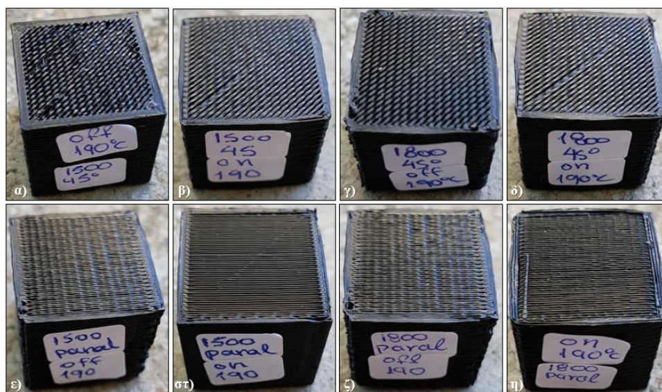
Εικόνα 4.50: Εκτύπωση του G-κώδικα στους 190 °C, πριν τη διαδικασία της θλίψης. α) Κατεύθυνση 45°, F1500 με 0% ισχύ του ανεμιστήρα, β) Κατεύθυνση 45°, F1500 με 100% ισχύ, γ) Κατεύθυνση 45°, F1800 με 0% ισχύ, δ) Κατεύθυνση 45°, F1800 με 100% ισχύ, ε) Κατεύθυνση 0°, F1500 με 0% ισχύ του ανεμιστήρα, στ) Κατεύθυνση 0°, F1500 με 100% ισχύ, ζ) Κατεύθυνση 0°, F1800 με 0% ισχύ, η) Κατεύθυνση 0°, F1800 με 100% ισχύ.
