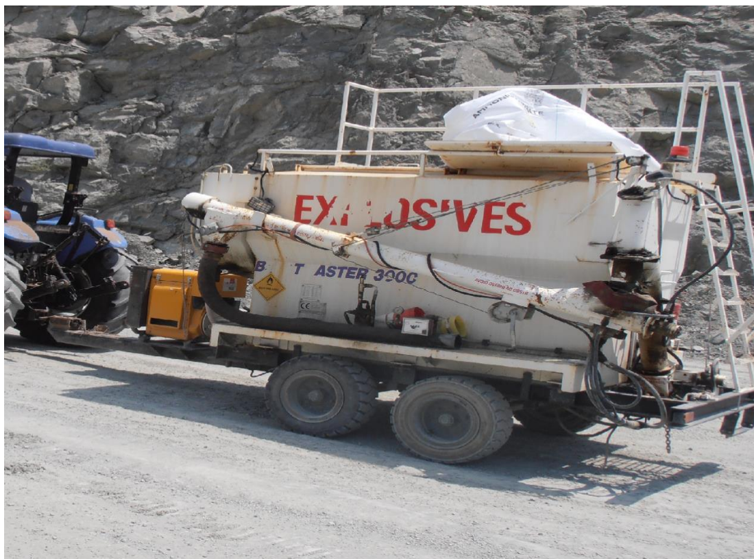
Εικόνα 4.2. Μηχανή ανάδευσης ANFO και γόμωσης διατριμμάτων.
