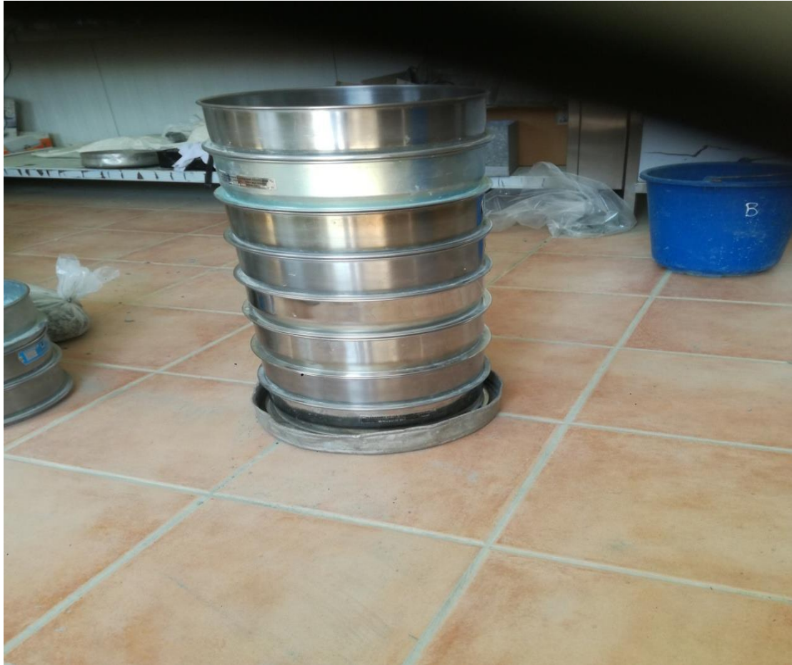
Εικόνα 7.5. Ταξινομημένη στήλη κοσκίων κατά φθίνουσα σειρά ανοίγματος από πάνω προς τα κάτω.
