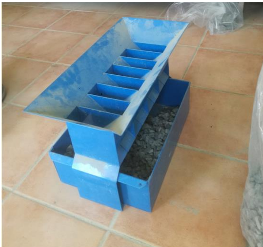
Εικόνα 7.2. Μηχανικός διαχωριστής χονδρόκοκκων αδρανών
