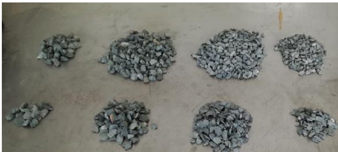
Εικόνα 7.10 : Κοκκομετρικά κλάσματα χωρισμένα σε διερχόμενα και παραμένον από τα κόσκινα με μπάρες.
