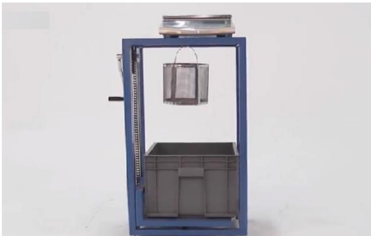
Εικόνα 7.11. Μηχανισμός μεθόδου με συρμάτινο καλάθι
