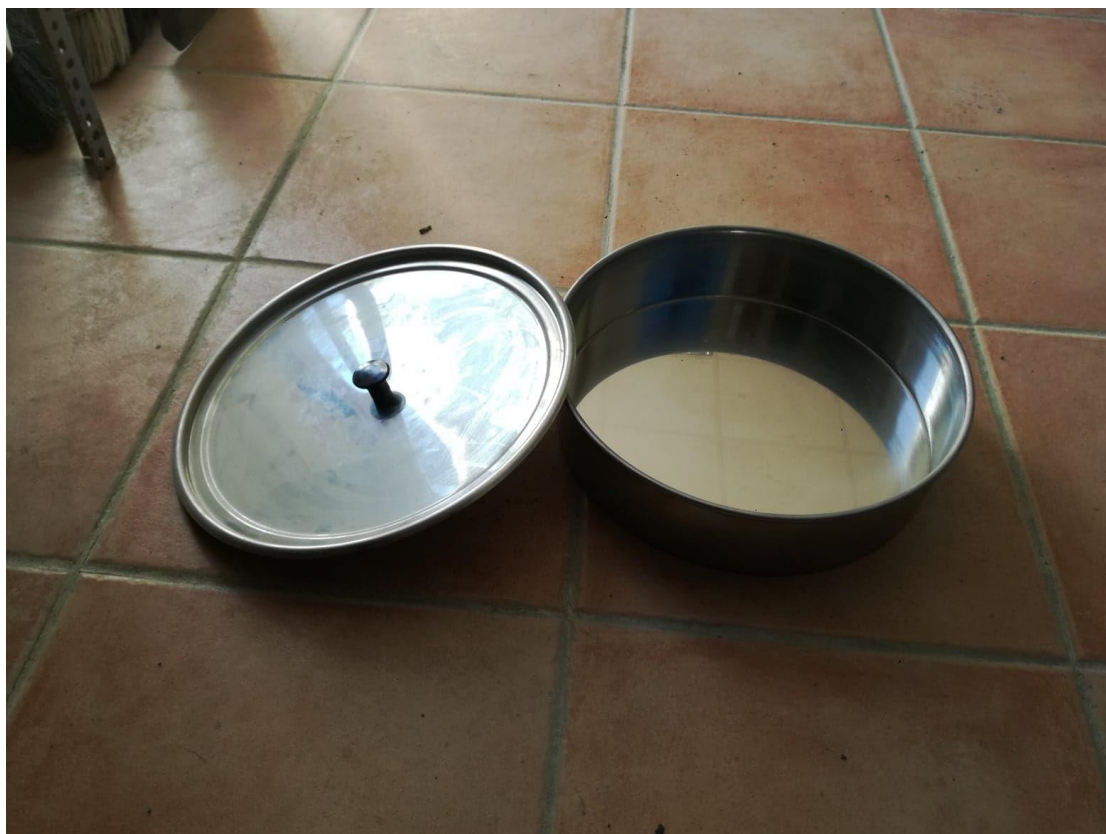
Εικόνα 7.6. Καπάκι και υποδοχέας κόσκινων
