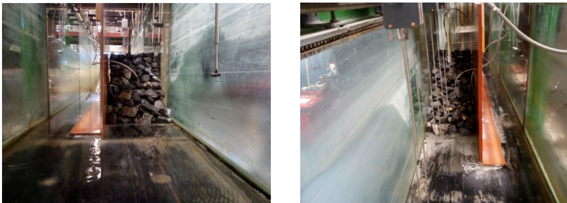
Σχήμα 3.5. Τελική άποψη κατασκευής: (α) Όψη πρηνούς προσήνεμης πλευράς (αριστερά), (β) Όψη πρηνούς υπήνεμης πλευράς (δεξιά).
