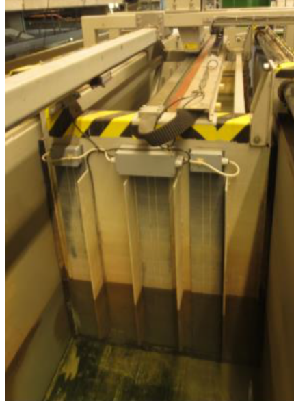
Σχήμα 3.2. Κυματογεννήτρια τύπου εμβόλου με διάταξη απορρόφησης ανακλώμενων κυματισμών.
