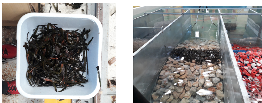
Σχήμα 3.14. Α) Ποσειδωνίες πριν την τοποθέτησή τους επάνω στο μοντέλο (αριστερά) και β) το μοντέλο SPB3 με τοποθετημένες ποσειδωνίες στην στέψη του (δεξιά).
