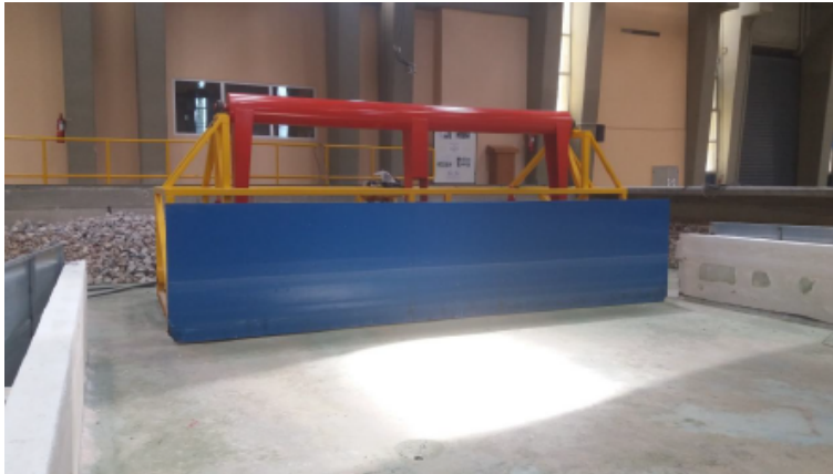
Σχήμα 3.8. (α) Όψη κυματογεννήτριας εταιρείας HR Wallinford (αριστερά), (β) Όψη μετρητή ανύψωσης (Wave Gauge) (δεξιά).
