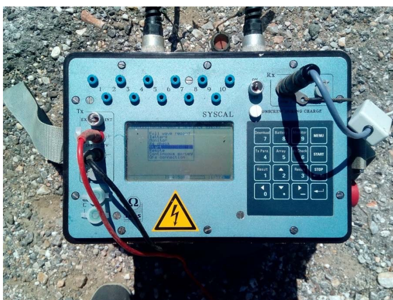
Εικόνα 4. 15: Το όργανο Syscal Pro που διαθέτει το εργαστήριο Εφαρμοσμένης Γεωφυσικής
