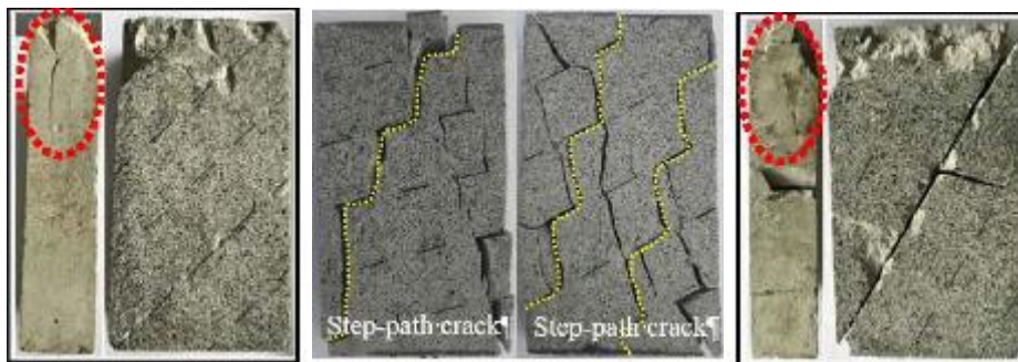
Εικόνα 6: α) σχισμός, β) διάτμηση, γ) διάτμηση, δ) επίπεδη ολίσθηση.
