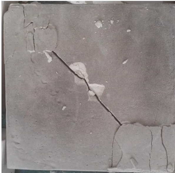
Εικόνα 26: Δοκίμιο S2 κατά την αστοχία του.
