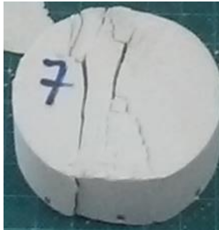
Εικόνα 12: Ρωγμές παράλληλες με τον άξονα φόρτισης κατά την αστοχία του δοκιμίου
