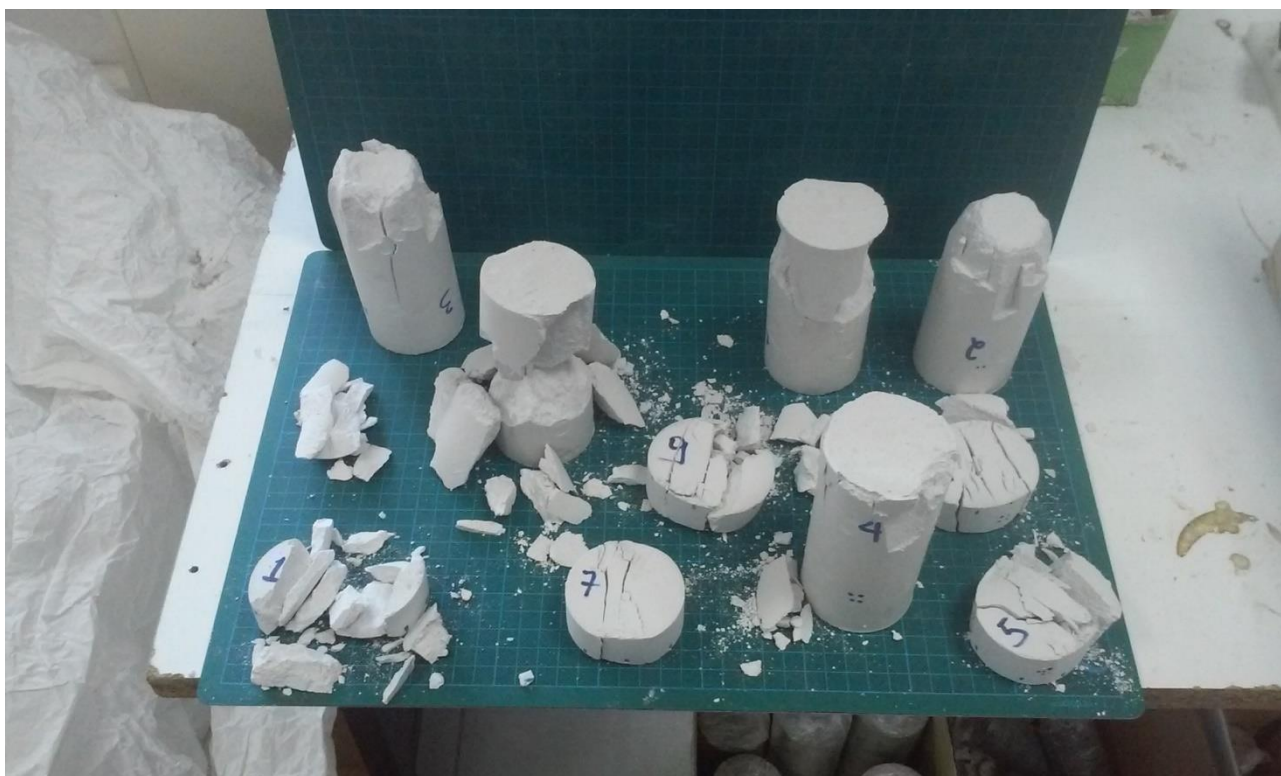
Εικόνα 41: Τρόποι θραύσης δοκιμίων.
