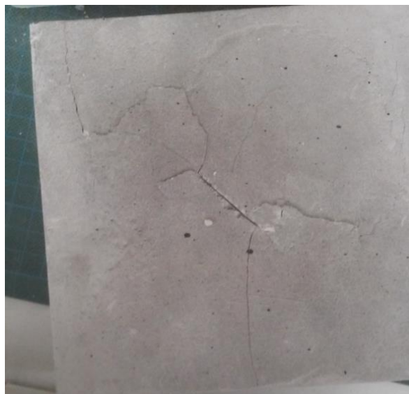
Εικόνα 22: Αστοχία του δοκιμίου P13
