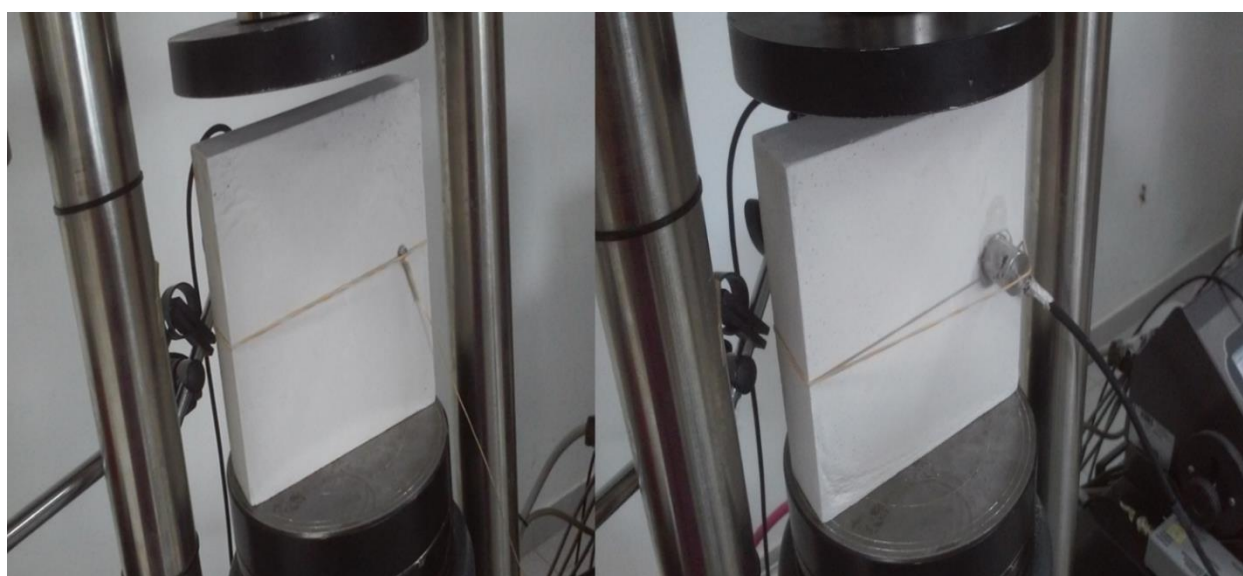
Εικόνα 14: Διάταξη πρισματικού δοκιμίου για τη δοκιμή μοσαξονικής θλίψης.
