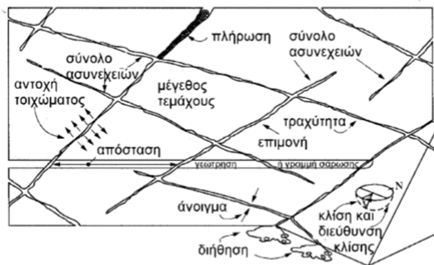
Σχήμα 1: Απεικόνιση γεωμετρικών παραμέτρων των ασυνεχειών (Σοφιανός & Νομικός, 2008).
