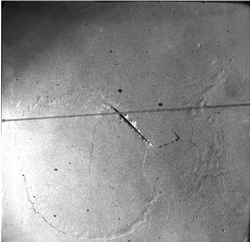
Εικόνα 19: α) δημιουργία εφελκυστικών ρωγμών (wing cracks), β) διάδοση των ρωγμών γ) αστοχία του δοκιμίου.
