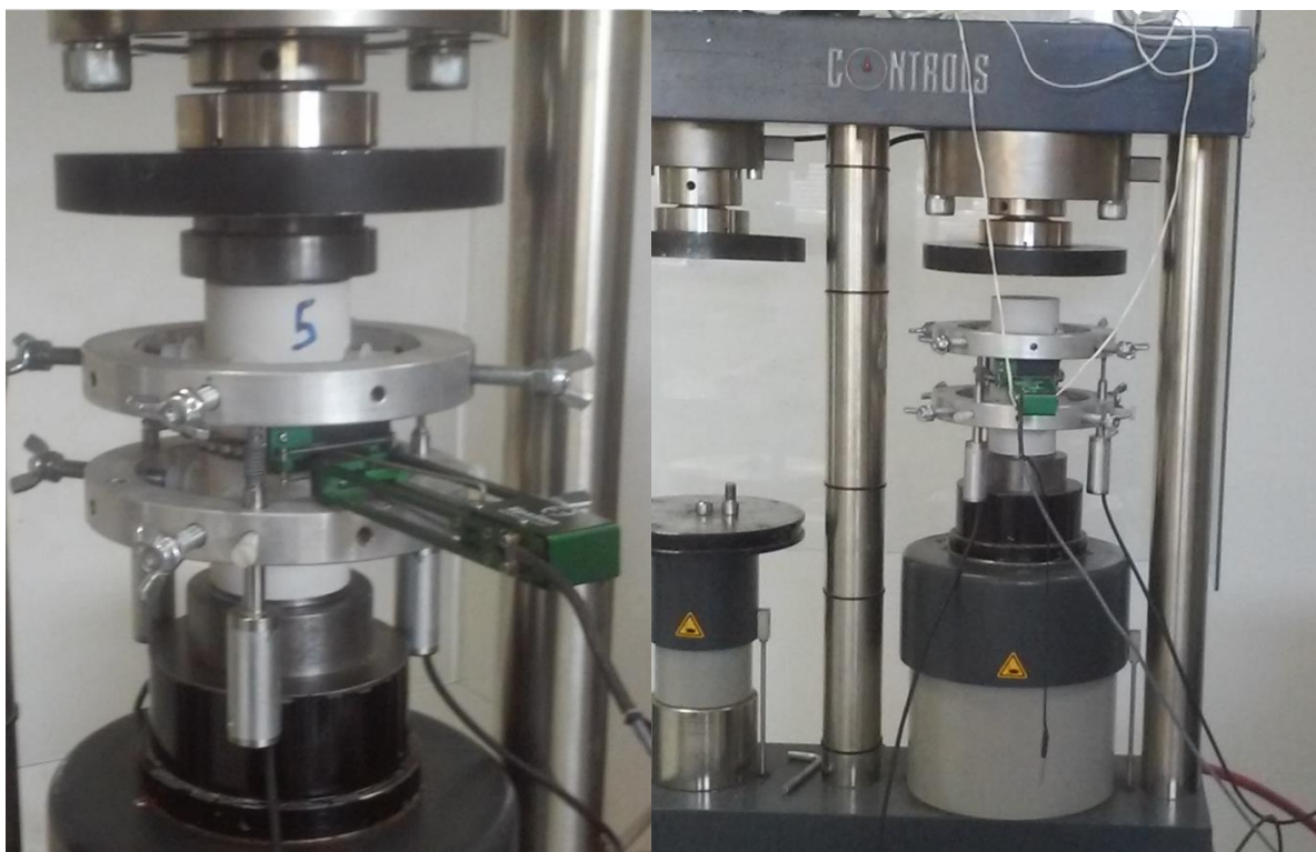
Εικόνα 13: Διάταξη δοκιμίου για τη δοκιμή μονοαξονικής θλίψης
