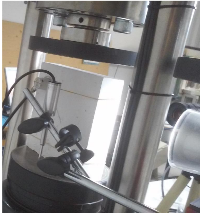
Εικόνα 18: Διάταξη δοκιμίου για τη δοκιμή μονοαξονικής θλίψης.
