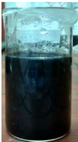
Σχήμα 5.1 Διάλυμα Α' συστατικού της εποξειδικής ρητίνης – τροποποιημένων CNTs μετά από 7 ημέρες
