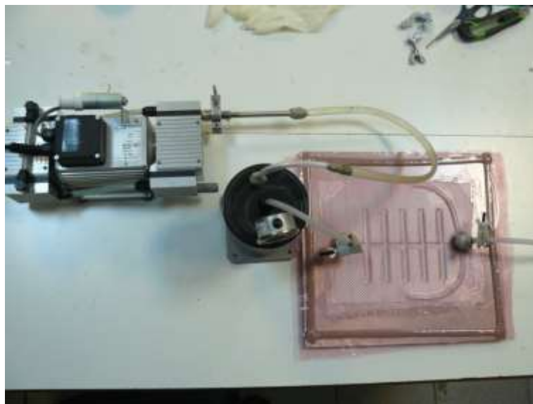
Σχήμα 6.11 Το Σύστημα έγχυσης υπό κενό, αφού έχει επέλθει το κενό
