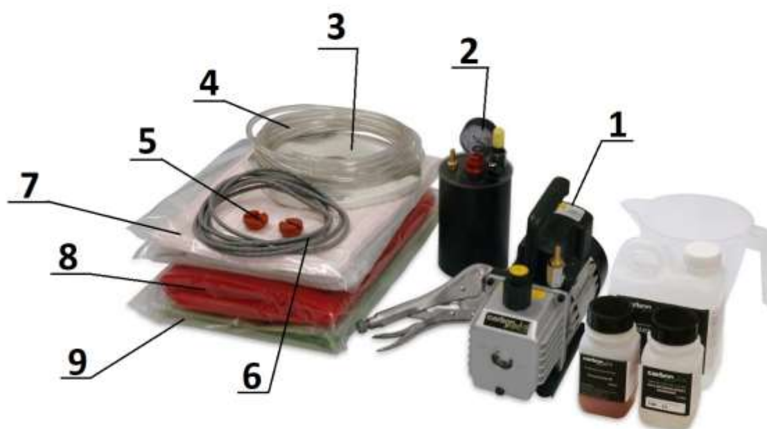
Σχήμα 6.1 Εξοπλισμός για την έγχυση υπό κενό
