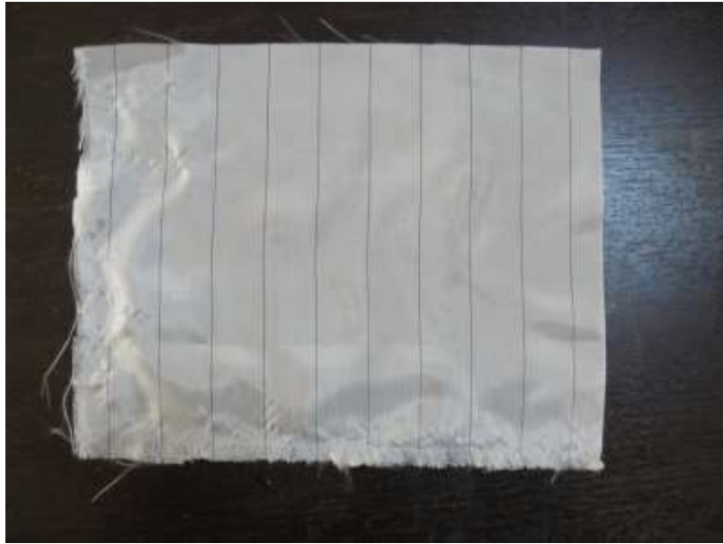
Σχήμα 6.6 Ύφασμα αποκόλλησης (peel-ply)
