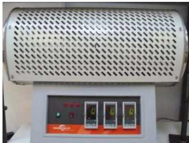
Σχήμα 4.1 Φούρνος του αντιδραστήρα CVD που χρησιμοποιήθηκε
