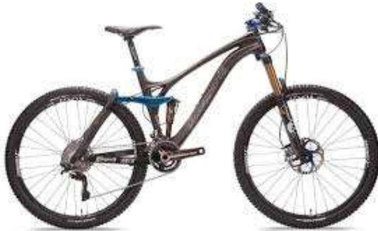
Σχήμα 2.10 Βραβευμένο ποδήλατο στο Tour de France 2006, κατασκευασμένο με CNTs [25]
