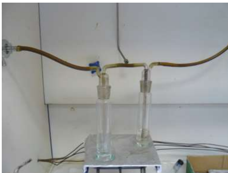
Σχήμα 4.3 Παγίδες για σωματίδια που παρασύρονται από την έξοδο του σωλήνα χαλαζία κατά τη διαδικασία σύνθεσης
