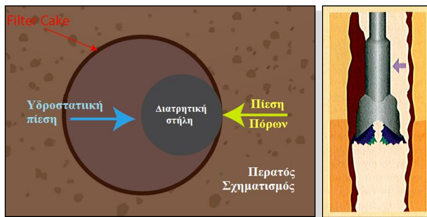
Εικόνα 4.4. Σχηματική απεικόνιση του φαινομένου διαφορικής παγίδευσης της διατρητικής στήλης. (Bailey, et al., 1991)
