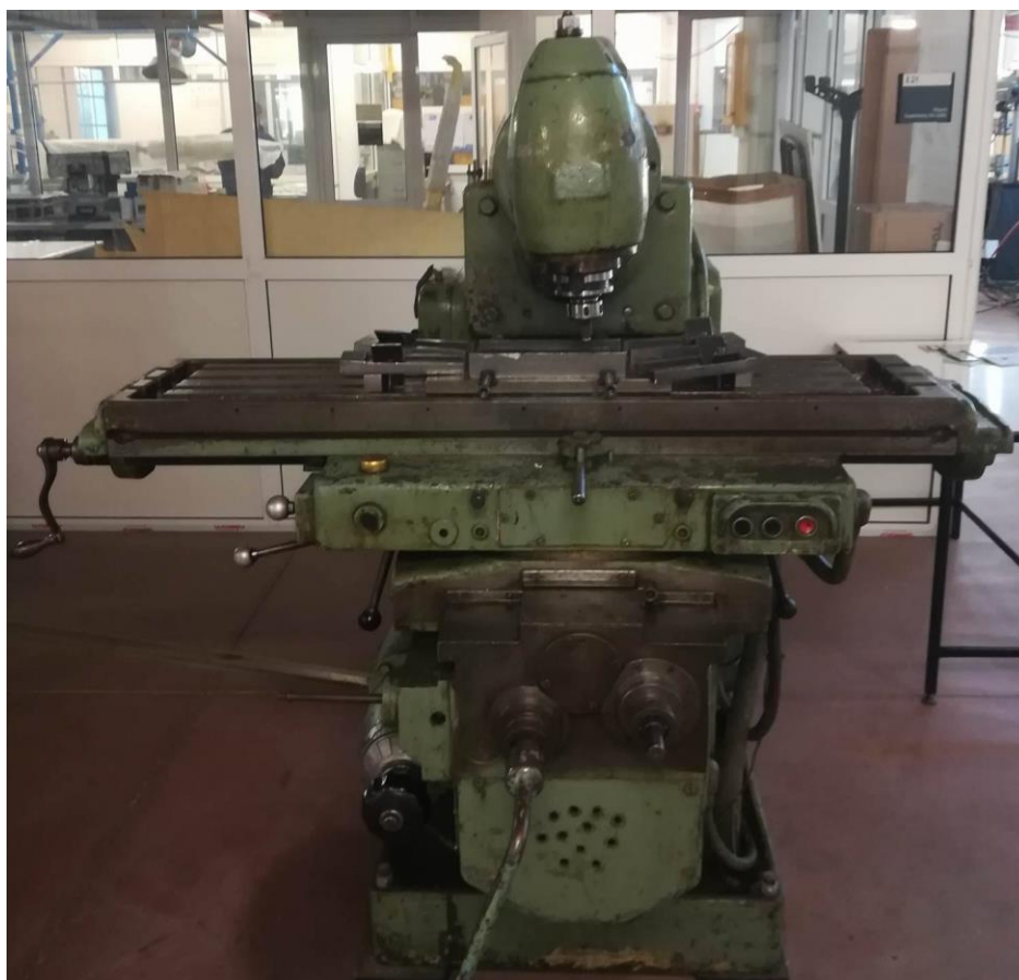
Εικόνα 2.4 : Κάθετη φρεζομηχανή τύπου “FU-32 (Universal Milling Machine, UMC CUGIR)” του Εργαστηρίου Ναυπηγικής Τεχνολογίας.
