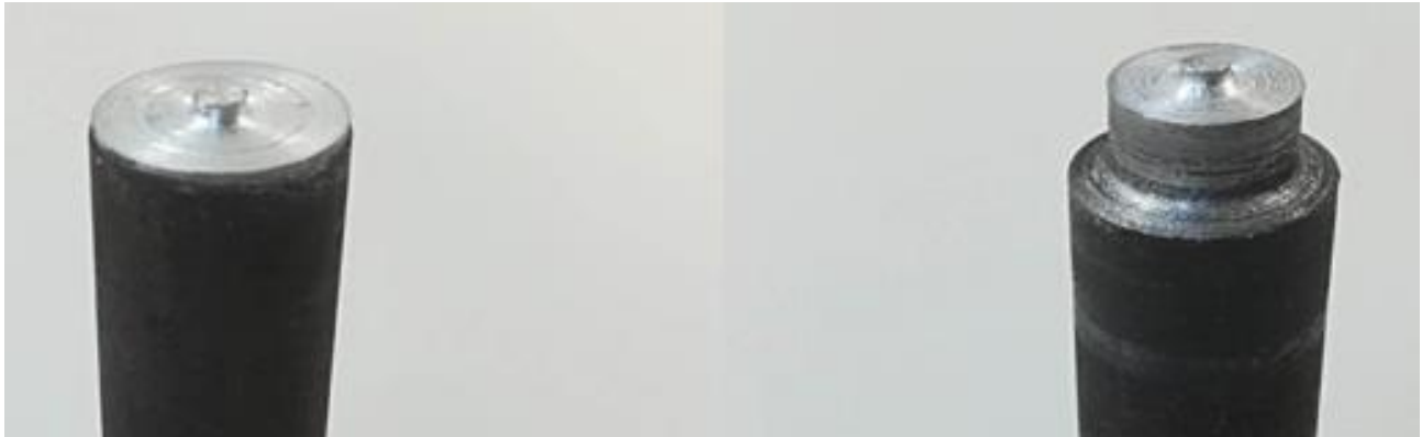
Εικόνα 2.5 : Το 1 ο εργαλείο συγκόλλησης FSW (αριστερά) με διάμετρο περιαιχενίου και πείρου 20 mm και 4 mm αντίστοιχα και το 2 ο εργαλείο συγκόλλησης FSW (δεξιά) με διάμετρο περιαιχενίου και πείρου 14 mm και 3,5 mm αντίστοιχα.
