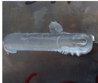
Εικόνα 3.27 : Άποψη ανεπιτυχούς ραφής της συγκόλλησης
