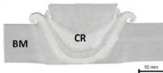
Εικόνα 1.10: Τομή δοκιμίων συγκολλημένων δια τριβής με τοξοειδή περιστροφή στην οποία διακρίνονται ο καταναλισκόμενος δακτύλιος (CR) και το μητρικό υλικό (BM).
