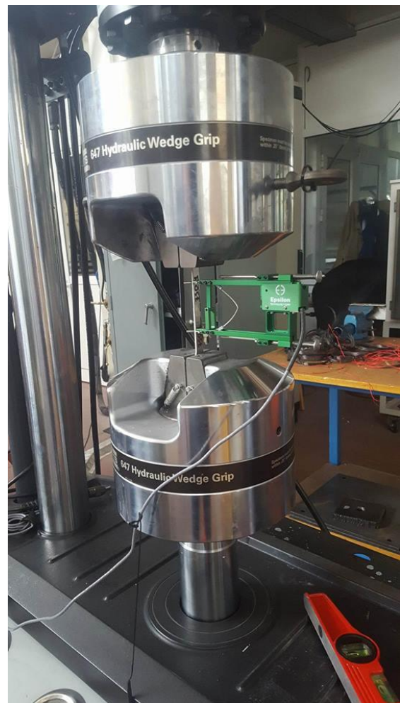
Εικόνα 2.12 : Υδραυλική μηχανή μηχανικών δοκιμών της MTS του Εργαστηρίου Ναυπηγικής Τεχνολογίας (Αριστερά). Στο υπό μελέτη δοκίμιο παρατηρείται τοποθετημένο το επιμηκυνσιόμετρο “Epsilon” (Δεξιά).
