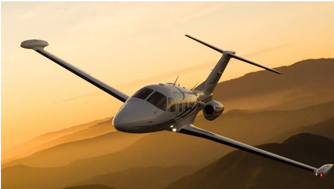
Εικόνα 1.30 : Το αεροσκάφος Eclipse 500 business jet, στο οποίο έγινε για πρώτη φορά χρήση της μεθόδου FSW με σκοπό την αντικατάσταση των μηχανικών συνδέσεων.
