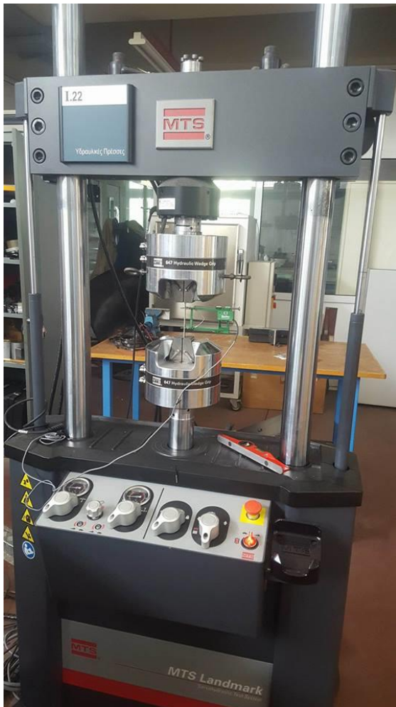
Εικόνα 2.12 : Υδραυλική μηχανή μηχανικών δοκιμών της MTS του Εργαστηρίου Ναυπηγικής Τεχνολογίας (Αριστερά). Στο υπό μελέτη δοκίμιο παρατηρείται τοποθετημένο το επιμηκυνσιόμετρο “Epsilon” (Δεξιά).
