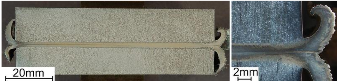
Εικόνα 1.8: Εικόνα οπτικού μικροσκοπίου που δείχνει την αξονική τομή των συγκολλημένων τεμαχίων ευτηκτοειδούς χάλυβα με τροχιακή συγκόλληση δια τριβής.
