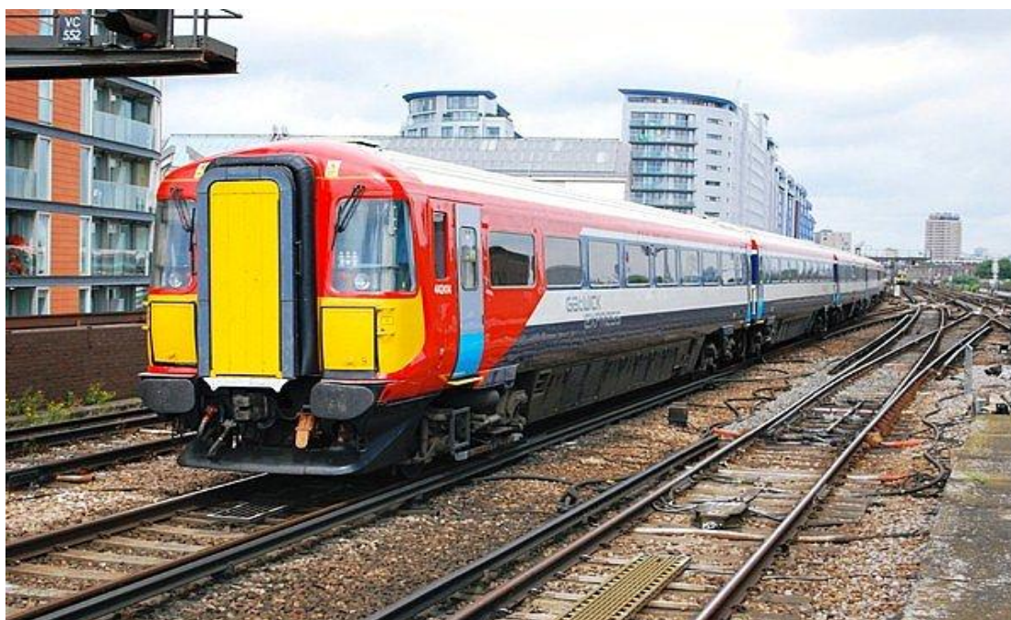
Τροφοδοσία από τρίτη ράγα στην αμαξοστοιχία British Class 442 στην περιοχή Battersea του νοτιοδυτικού Λονδίνου
