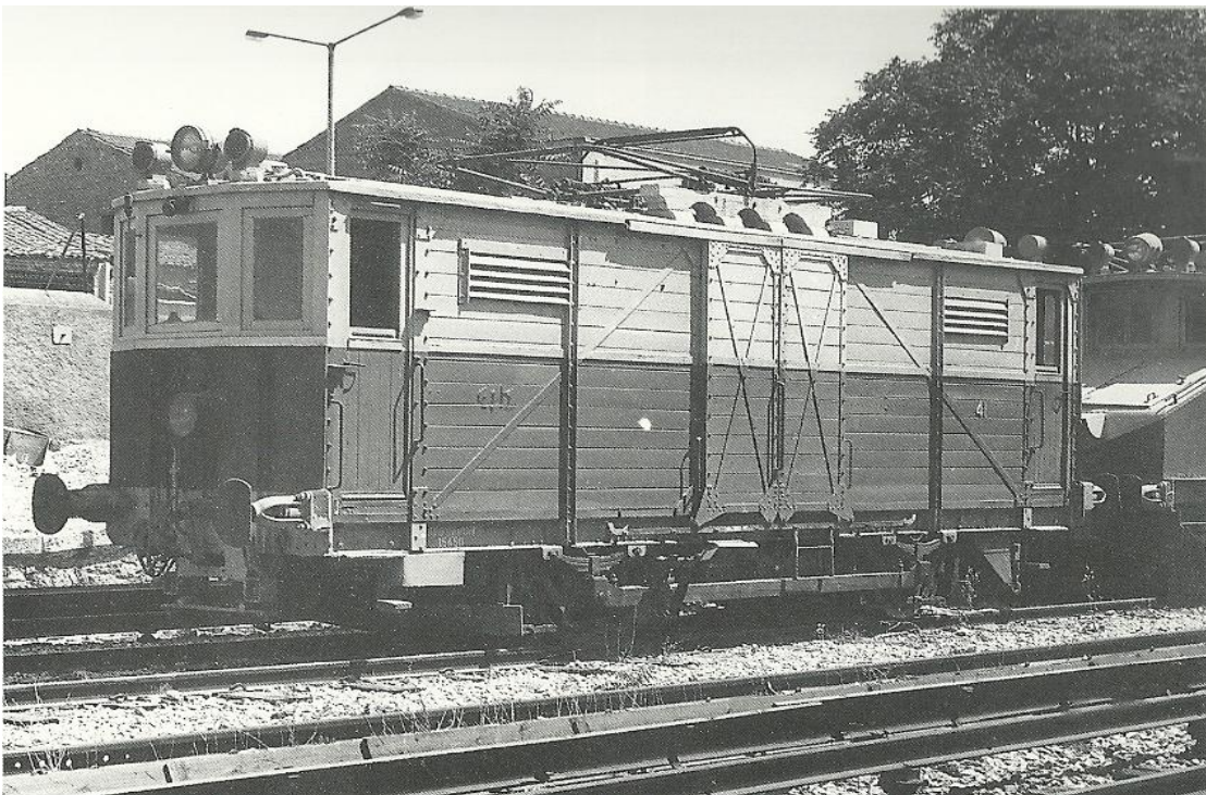
Το «φουργκόνι», η ηλεκτρική εμπορική αυτοκινητοάμαξα Νο 41 του ΣΑΠ που είχε επίσης διπλή δυνατότητα ρευματοληψίας από το εναέριο ηλεκτρικό δίκτυο του τραμ και το ισόγειο του τραίνου του ΣΑΠ/ΕΗΣ.
