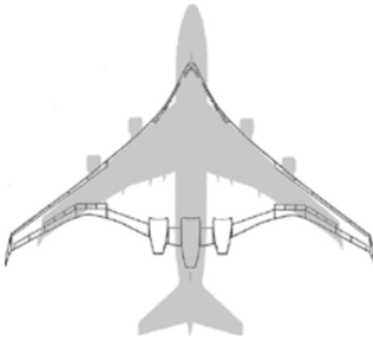
Σχήμα 2-2. Σύγκριση συμβατικού αεροσκάφους με τη διάταξη Blended Wing Body.
