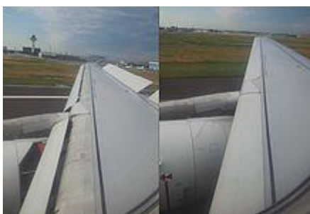
Σχήμα 1.3: Υπεραντωτικές διατάξεις (slats) κατά την προσγείωση (Airbus A319)
