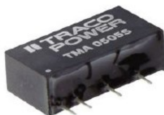
Σχήμα 4.9: Τροφοδοτικό TMA 1505 της εταιρίας TRACO POWER.
