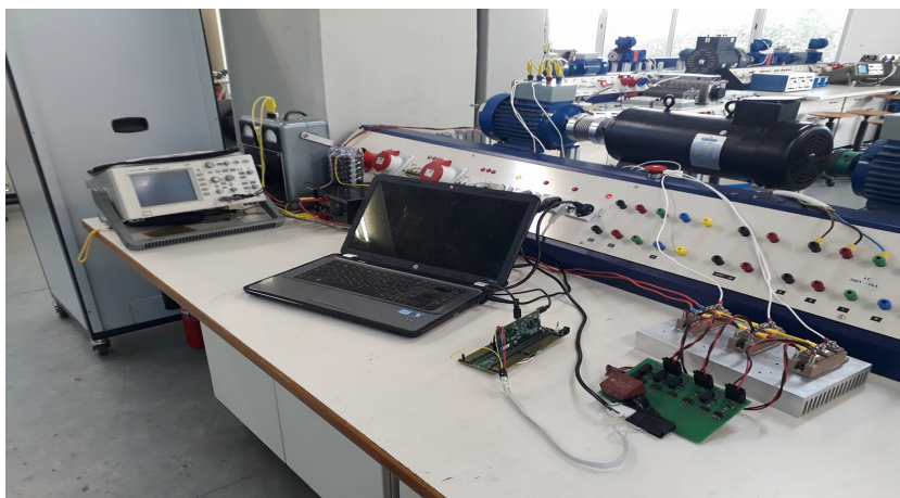
Σχήμα 4.27: Πάγκος εργασίας για την επιβεβαίωση λειτουργίας του συστήματος ισχύος.
