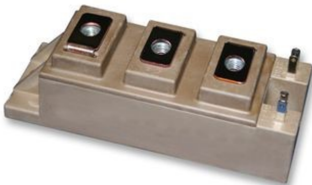
Σχήμα 4.4: Ημιγέφυρα 2MBI100TA-060-50 της εταιρίας Fuji Electric Device Technology.
