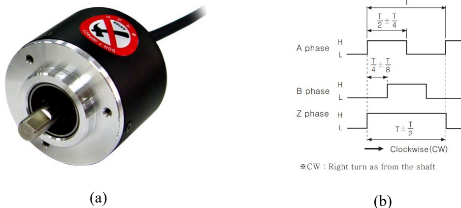
Σχήμα 4.40: (a) Encoder E50S8 της εταιρίας Autronics. (b) Έξοδοι του encoder.
