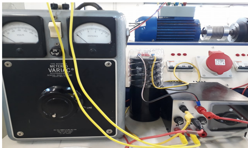
Σχήμα 4.29: Αυτομετασχηματιστής και ανορθωτής.
