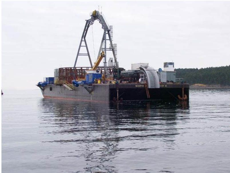
Εικόνα 2.14: Φορτηγίδα πόντισης υποθαλάσσιων ενεργειακών καλωδίων. (Πηγή: www.hibbardinshore.com )
