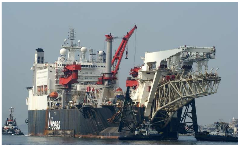
Εικόνα 3.9: Πλοίο τοποθέτησης υποθαλάσσιων αγωγών «Solitaire». (Πηγή: www.shipspotting.com )
