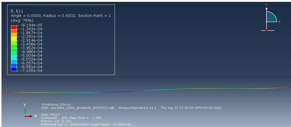
Εικόνα 6.32: Παραμορφώσεις αγωγού για 50, 100, 150m πάχους ιζηματογενούς στρώσης.
