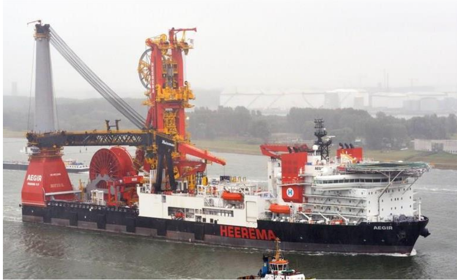
Εικόνα 3.10: Πλοίο τοποθέτησης υποθαλάσσιων αγωγών με τη μέθοδο J-lay «DCV Aegir». (Πηγή: www.marinetraffic.com )
