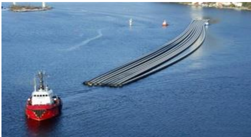
Εικόνα 3.8: Μέθοδος εγκατάστασης υποθαλάσσιου αγωγού επιφανειακής ρυμούλκησης. (Πηγή: Offshore Fleet: Offshore industry and technology journal )
