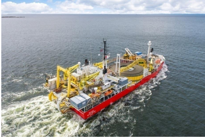
Εικόνα 2.12: Πλοίο πόντισης υποθαλάσσιων ενεργειακών καλωδίων C/S «Skagerrak». (Πηγή: www.worldoil.com )
