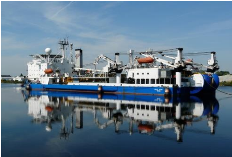
Εικόνα 2.13: Πλοίο πόντισης υποθαλάσσιων ενεργειακών καλωδίων C/S «Guilio Verne». (Πηγή: www.vesseltracker.com )
