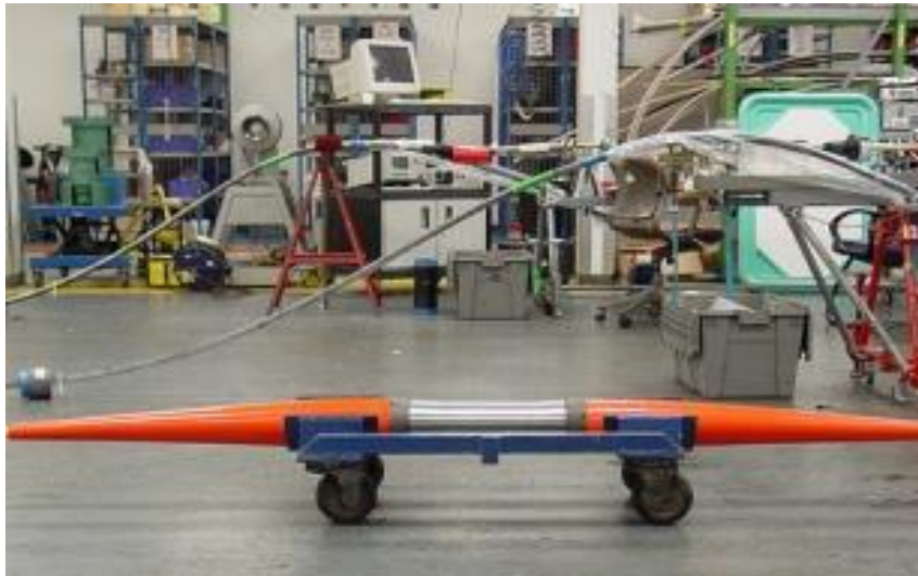
Εικόνα 2.20: Αναμεταδότης (repeater) υποθαλάσσιου καλωδίου που πρόκειται να χρησιμοποιηθεί για τα υποθαλάσσια σύνδεση της Νιγηρίας με το Καμερούν (Nigeria Cameroon Submarine Cable System – NCSCS). (Πηγή: www.communicatonsafrica.com )
