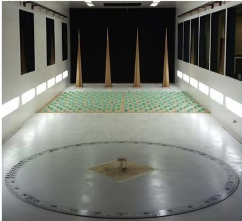
Σχήμα 6.4 Πειράματα για την προσομοίωση της ροής γύρω από σώμα κυβικής μορφής (14)
