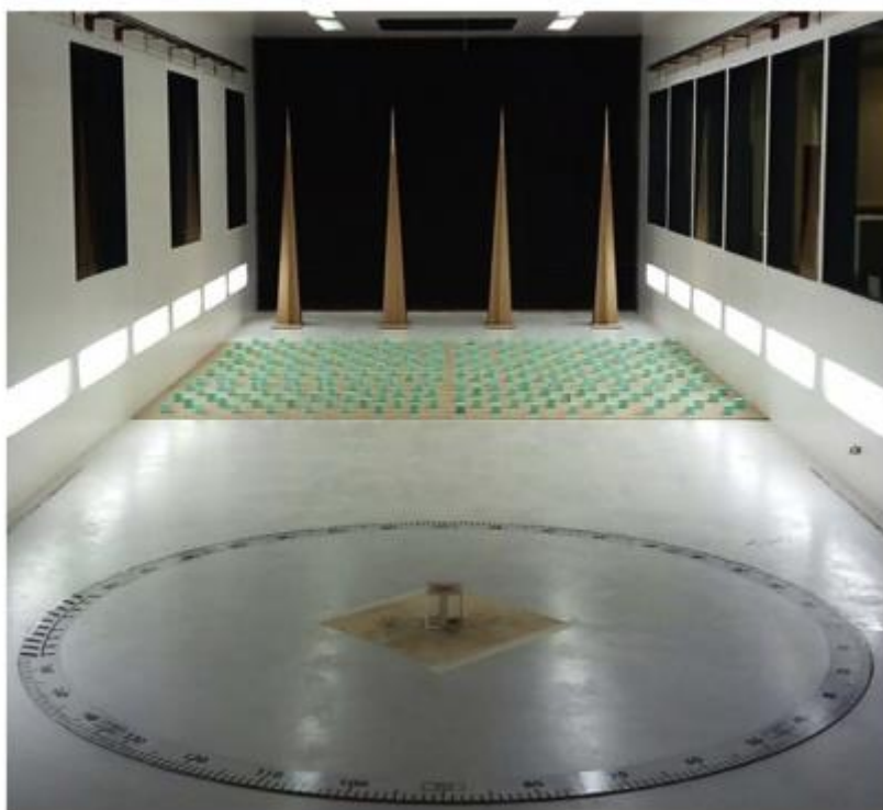
Σχήμα 3.13 Πειράματα για την προσομοίωση της ροής γύρω από σώμα κυβικής μορφής εκτεθειμένο σε ροή αέρα ΑΟΣ στην αεροσήραγγα (14)
