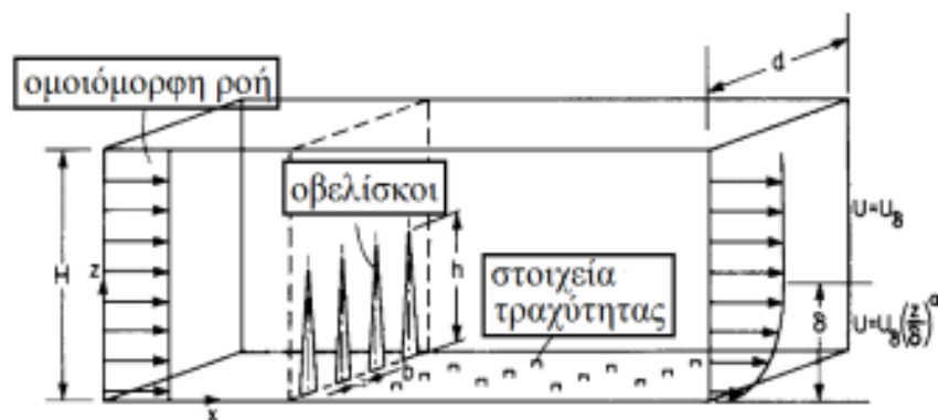
Σχήμα 6.2 Πειραματική διάταξη προσομοίωσης οριακού στρώματος κατά Irwin (14)
