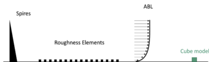
Σχήμα 6.3 Σχηματική απεικόνιση της πειραματικής διάταξης των οβελίσκων και των στοιχείων τραχύτητας για την προσομοίωση του ΑΟΣ. (24)
