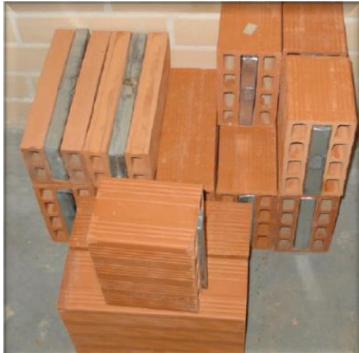
Σχήμα 5.4.3 Παράδειγμα μακροενθυλάκωσης σε τούβλα [43]
