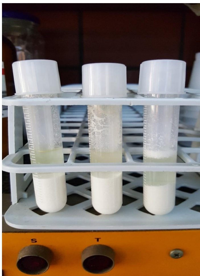
Εικόνα 3: Δείγματα κατά τη μέτρηση της διαβροχής. Από αριστερά προς τα δεξιά σκόνη γιαουρτιού με ξήρανση υπό κατάψυξη με 0% λιπαρά, 2% λιπαρά και 5% λιπαρά. Στο μεσαίο δείγμα τα λιπαρά έχουν κολλήσει στα τοιχώματα και λίγα επιπλέουν, ενώ στο δεξί δείγμα φαίνεται ξεκάθαρα ο διαχωρισμός των λιπαρών.
