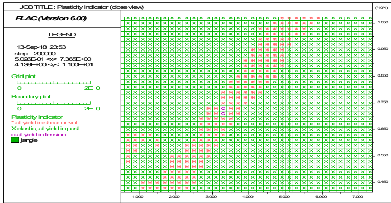
Σχήμα 237 Εικόνα της πλαστικοποίησης των ζωνών του μοντέλου. Με τις πράσινες γραμμές δείχνεται η παρουσία ασυνεχειών ubiquitous joint στις ζώνες του μοντέλου.
