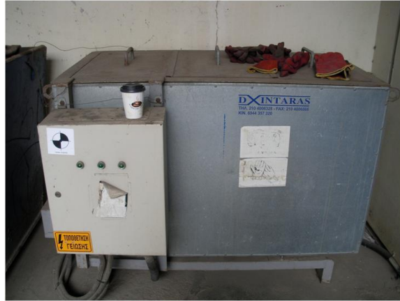
Εικόνα 6.3: Συσκευή η οποία χρησιμοποιήθηκε για την γήρανση των δοκιμών και η οποία λειτουργεί με αναβράζον νερό.
