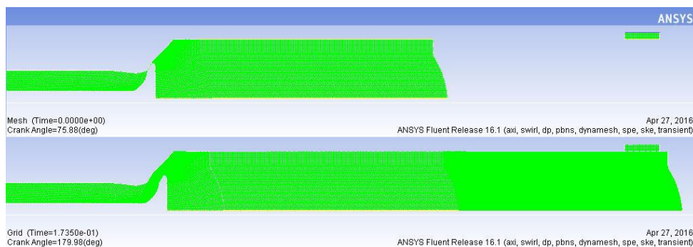
Εικόνα 4.2: Πλέγμα μοντέλου CFD, στις 76 deg CA (πάνω εικόνα) και στις 180 deg CA (κάτω εικόνα).
