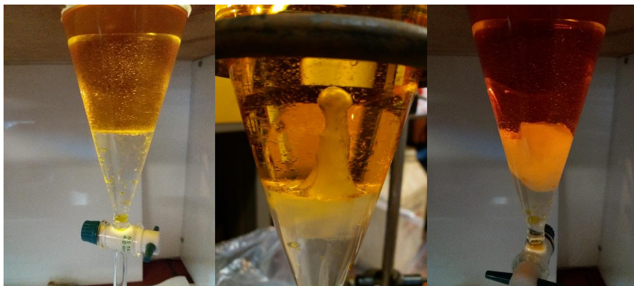
Εικόνα 3-1: Μικρόκοσμοι με FAME μετά από χρόνο αποθήκευσης 180 ημερών (DWM, CWM και BTM από τα αριστερά προς τα δεξιά αντίστοιχα).
