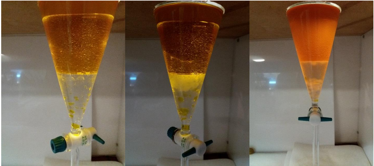
Εικόνα 0-5: Μικρόκοσμοι με FAME μετά από χρόνο αποθήκευσης 90 ημερών (DWM, CWM και BTM από τα αριστερά προς τα δεξιά αντίστοιχα).
