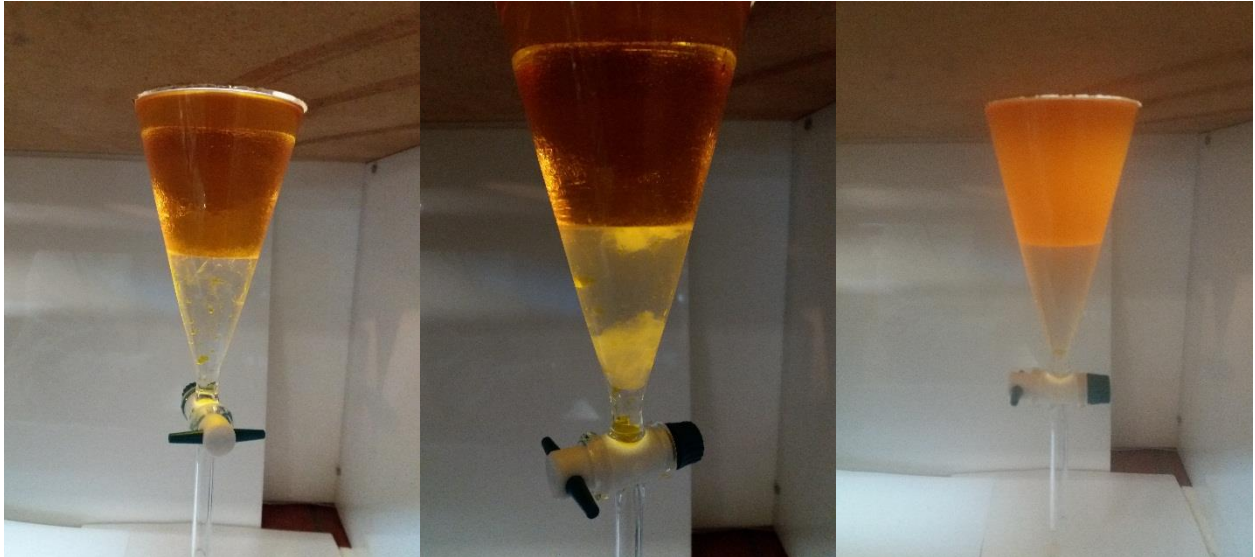
Εικόνα 0-3: Μικρόκοσμοι με FAME μετά από χρόνο αποθήκευσης 30 ημερών (DWM, CWM και BTM από τα αριστερά προς τα δεξιά αντίστοιχα).
