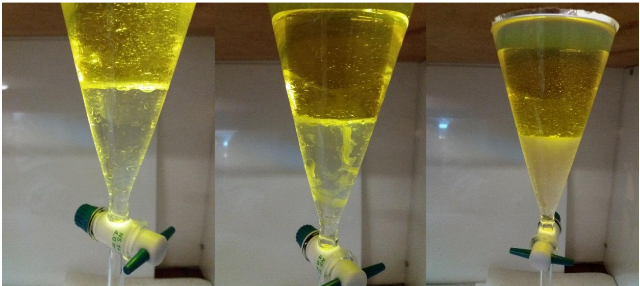
Εικόνα 0-6: Μικρόκοσμοι με B7 μετά από χρόνο αποθήκευσης 90 ημερών (DWM, CWM και BTM από τα αριστερά προς τα δεξιά αντίστοιχα).
