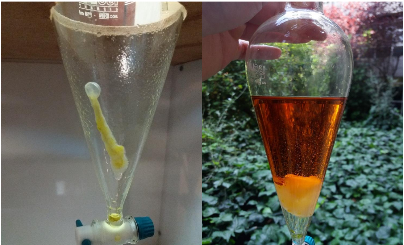
Εικόνα 0-10: Προσκόλληση μικροβιακού συσσωματώματος στα τοιχώματα διαχωριστικής φιάλης (FAME CWM - αριστερά), κατακράτηση υγρασίας εντός της φάσης καυσίμου (FAME BTM - δεξιά).
