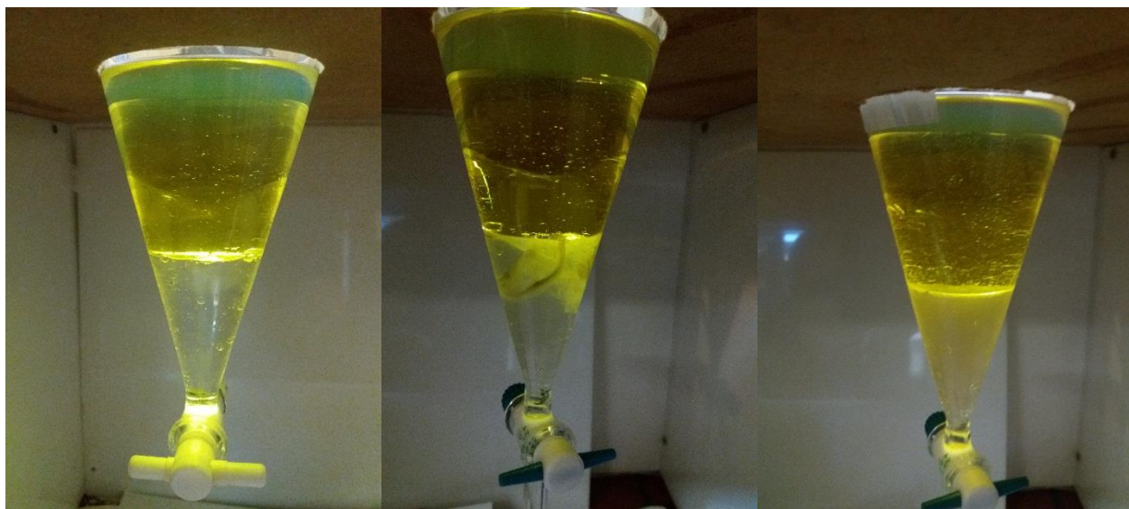
Εικόνα 3-2: Μικρόκοσμοι με Β7 μετά από χρόνο αποθήκευσης 180 ημερών (DWM, CWM και BTM από τα αριστερά προς τα δεξιά αντίστοιχα).
