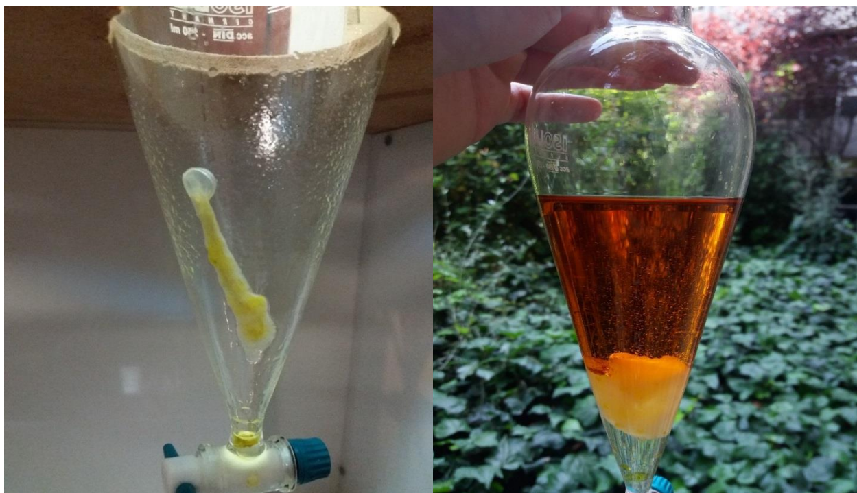
Εικόνα 3-3: Προσκόλληση μικροβιακού συσσωματώματος στα τοιχώματα διαχωριστικής φιάλης (FAME CWM - αριστερά), κατακράτηση υγρασίας εντός της φάσης καυσίμου (FAME BTM - δεξιά).
