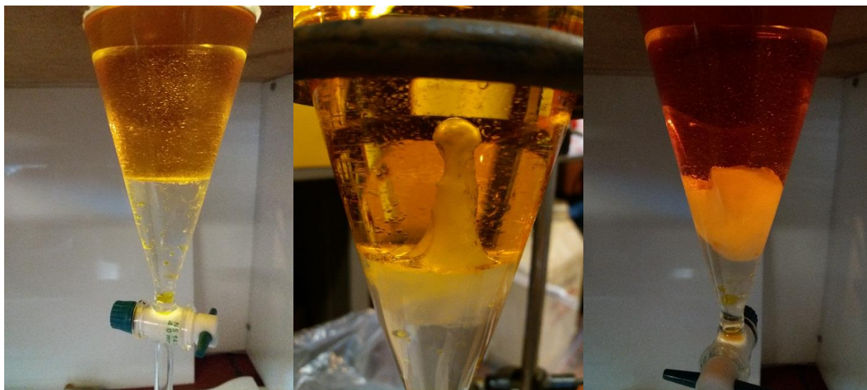
Εικόνα 0-8: Μικρόκοσμοι με FAME μετά από χρόνο αποθήκευσης 180 ημερών (DWM, CWM και BTM από τα αριστερά προς τα δεξιά αντίστοιχα).
