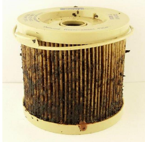
Εικόνα 1-2: Μικροβιακές αποθέσεις σε φίλτρο αντλίας καυσίμου.
