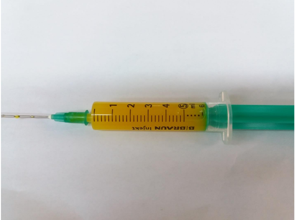
Εικόνα 0-14: Θολή όψη μικροβιακά επιμολυσμένου FAME κατόπιν διορθωτικής δράσης
