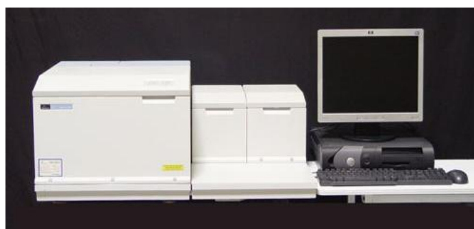
ΕΙΚΟΝΑ 2.3: Φασματογράφος Υπέρυθρης ακτινοβολίας Perkin Elmer Spectrum GX
