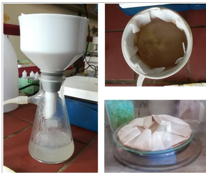
Σχήμα 26. Διάταξη διήθησης (αριστερά), στερεό υπόλειμμα κατά τη διήθηση (επάνω) και μετά (κάτω)
