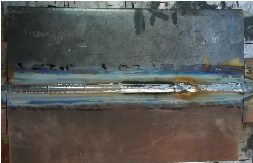
Εικ. 3.17 Η ρίζα της συγκόλλησης από την κάτω μεριά, μετρά την αφαίρεση της επικάλυπτρα. Και εδώ παρατηρείται ομαλή επιφάνεια, ελλείπει σφαλμάτων.
