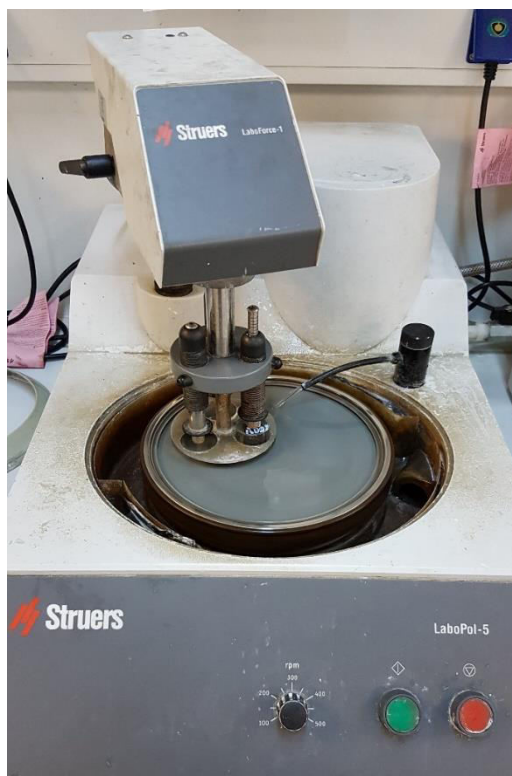
Εικ. 3.20 Λειαντική μηχανής Struers LaboPol – 5του Ε.Ν.Τ.
