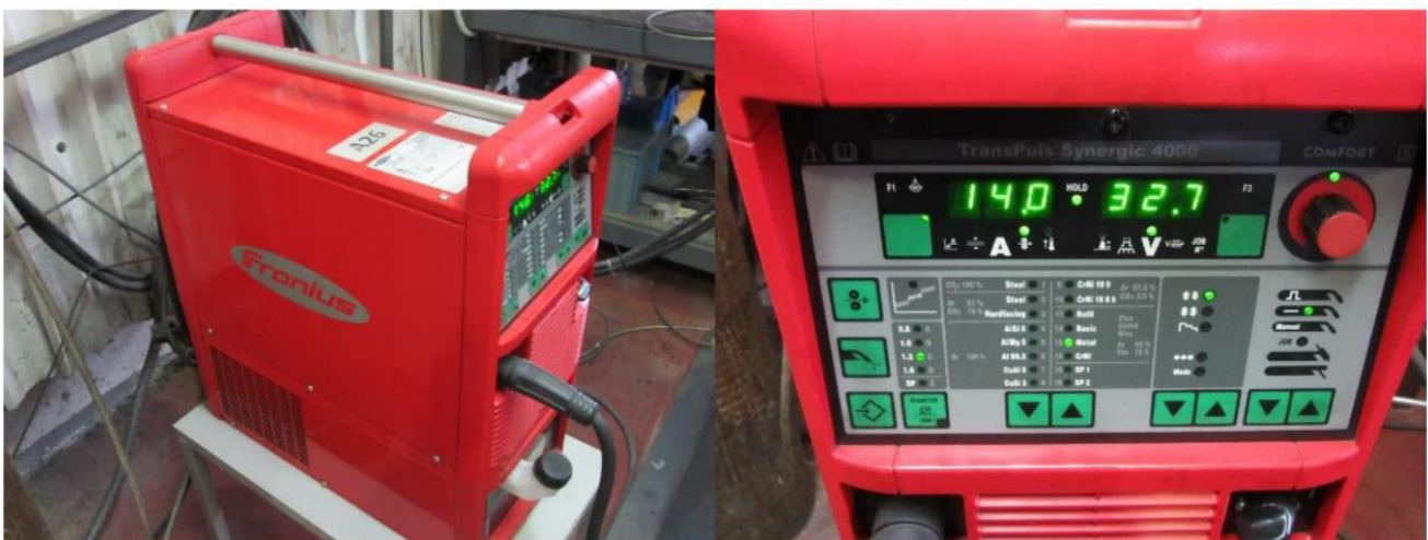
Εικ. 3.11 Η μηχανή συγκόλλησης TransPuls Synergic 4000
