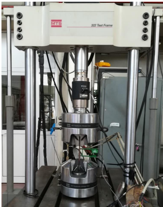
Εικ. 3.28 Η μηχανή εφελκυσμού “MTS 322 Test Frame” του Ε.Ν.Τ.
