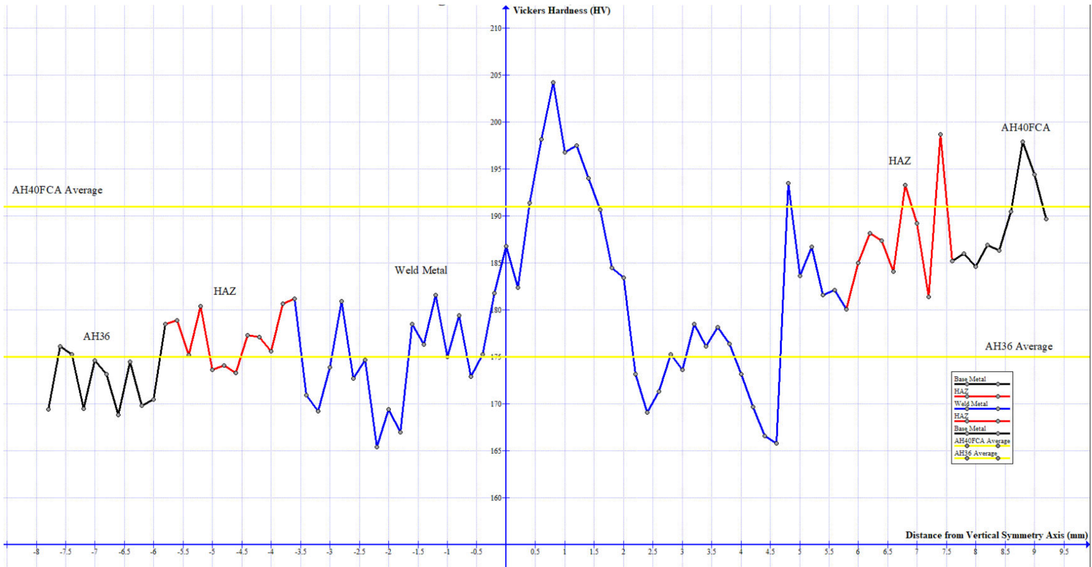
Εικ. 4.6 Οριζόντιες μετρήσεις μικροσκληροτήτων Vickers HV 0.3 στο 1/3 του πάχους του δοκιμίου, Κατηγορίας B1
