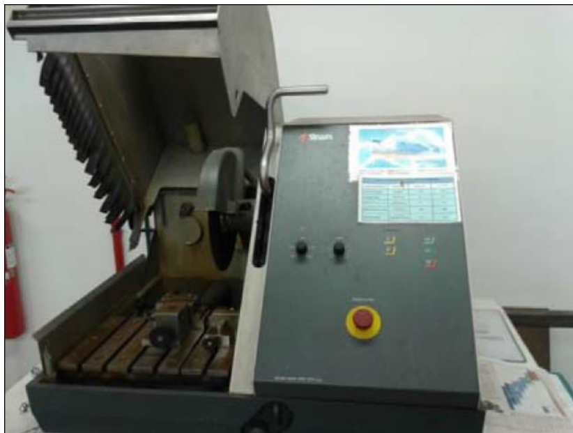
Εικ. 3.19 Δισκοτόμος Struers Discotom 50, του Ε.Ν.Τ.
