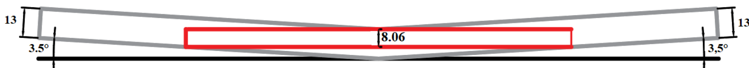
Εικ. 3.24 Γεωμετρικός προσδιορισμός πάχους φρεζαρίσματος.
