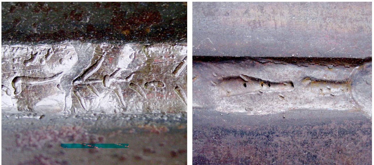
Εικόνα 1.9 Χαρακτηριστική μορφή των ατελειών τύπου worm tracks.
