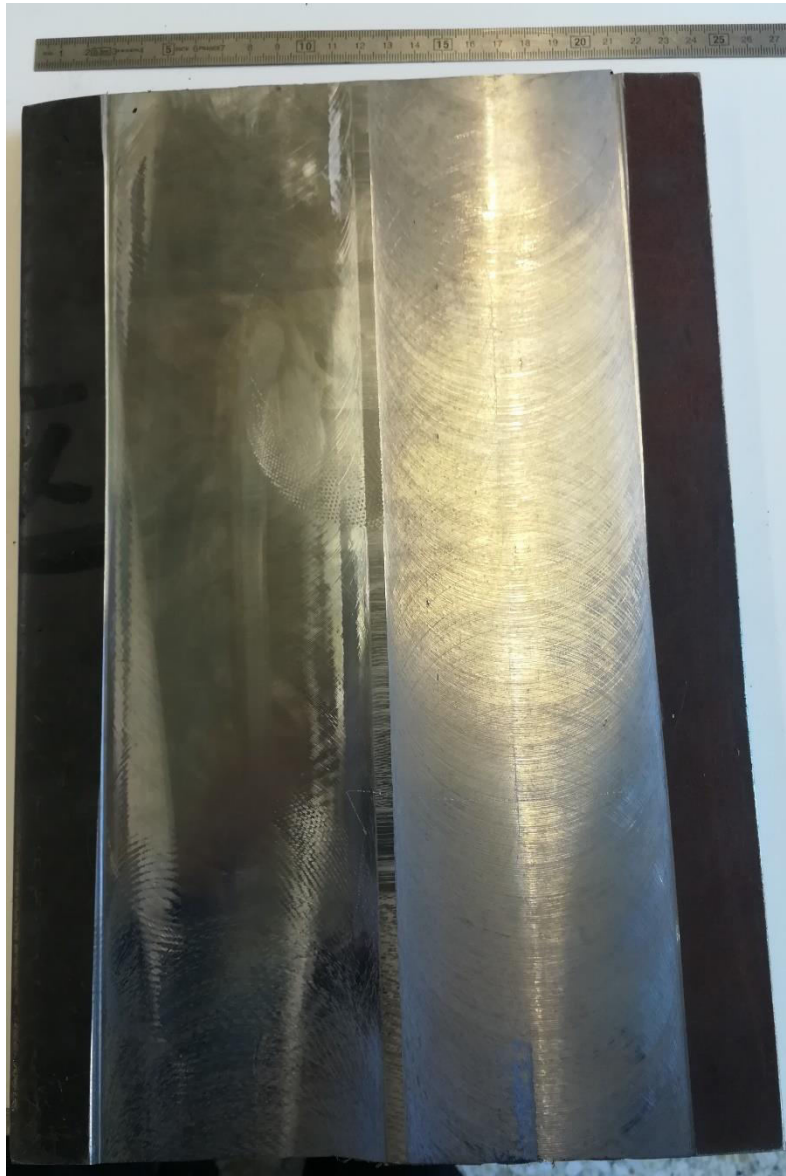
Εικ. 3.26 Η φρεζαρισμένη, επίπεδη πλακά, ωφέλιμου πάχους 7.5mm.
