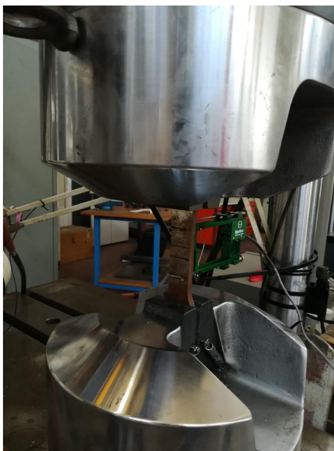
Εικ. 3.29 Διάταξη μέτρησης πειράματος εφελκυσμού.
