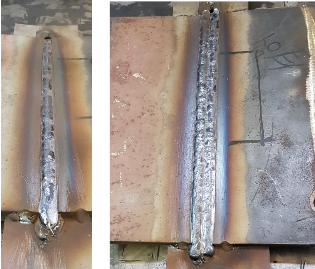
Εικ. 3.16α, 3.16β Η επιφάνεια της συγκόλλησης μετά το 5 ο κορδόνι (α) και μετά τα δυο τελευταία κορδόνια (β). Στο 5 ο κορδόνι παρατηρείται η απαιτούμενη ομαλή επιφάνεια για την εναπόθεση των δυο τελευταίων κορδονιών, τα οποία με τη σειρά τους είναι ομαλά, ελλείπει σφαλμάτων.
