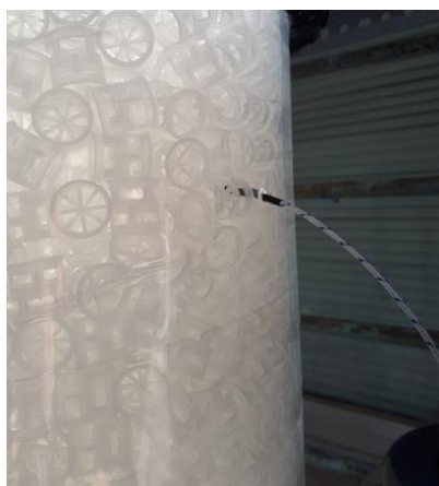
Σχήμα 7-4: Πληρωτικό υλικό Pall Rings
