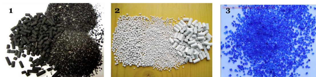
Σχήμα 2-9: Τυπικά προσροφητικά υλικά. (1) Ενεργοποιημένος Άνθρακας, (2) Ζεόλιθος, (3) Silica gel
