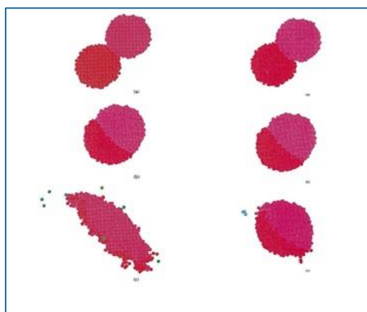
Εικόνα 25 : (α) Απεικονίσεις υπολογιστικής προσομοίωσης pendular state για υγρά συσσωματώματα για ιξώδες 10 mPa s και ταχύτητες κρούσης (a) 0.5 m/s, (b) 2.0 m/s και (c) 5.0 m/s. (β) Απεικονίσεις υπολογιστικής προσομοίωσης pendular state για υγρά συσσωματώματα για ταχύτητες κρούσης 2.0 m/s και ιξώδες (a) 100 mPa s, (b) 1 mPa s και (c) 1 mPa s/m/s (Lian ,1998).
