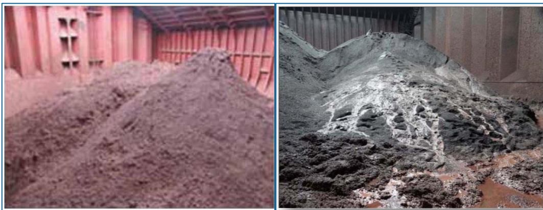
Εικόνα 8: Ρευστοποιημένο Μετάλλευμα του Νικελίου (Spencer & Tilsey,2011).
