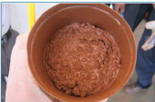
Εικόνα 18: Παρουσία Υγρασίας μετά τη διεξαγωγή του Can Test(Spencer & Tilsey,2011)
