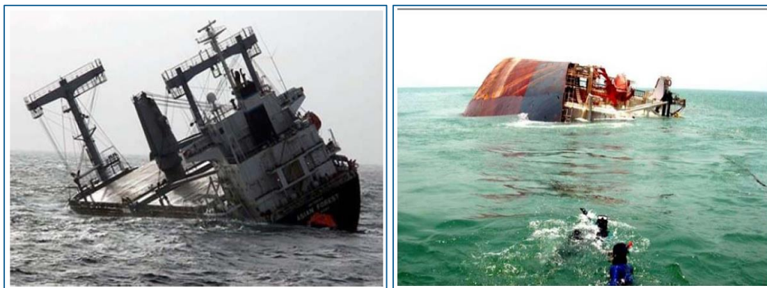
Εικόνα 10: Ανατροπή Πλοίου λόγω Ρευστοποίησης Φορτίου (Lomas R.,2012)
