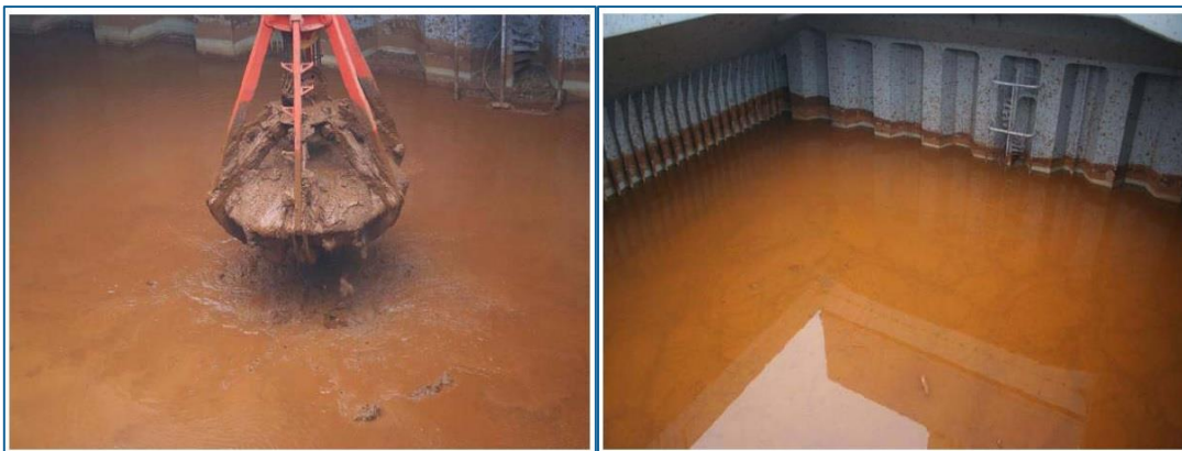
Εικόνα 7: Ρευστοποιημένο Μετάλλευμα του Νικελίου (Spencer & Tilsey,2011).
