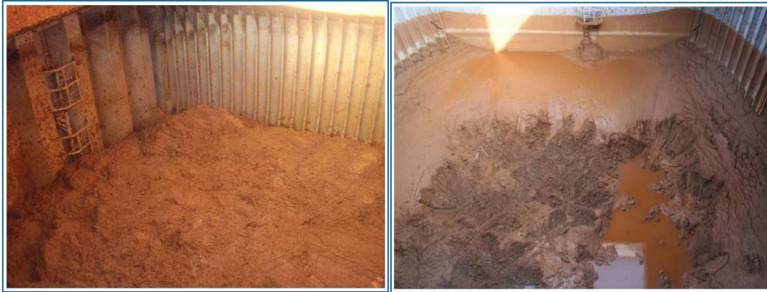
Εικόνα 6:(α) Ξηρό Μετάλλευμά του Νικελίου (β) Ρευστοποιημένο Μετάλλευμα του Νικελίου (Spencer & Tilsey,2011).
