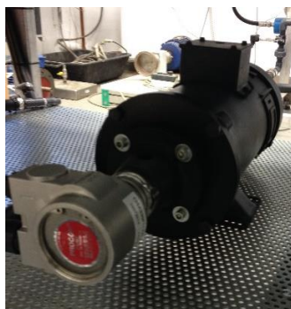
Εικόνα 8.3: Αντλία και DC κινητήρας τροφοδοσίας
