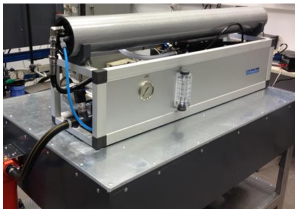
Εικόνα 8.1: Μονάδα αφαλάτωσης αντίστροφης ώσμωσης τύπου Clark
