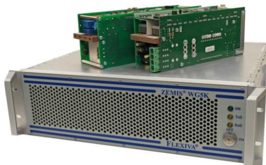
Εικόνα 8.7: Σύστημα FLEXIVA (εμπρός όψη) και μονάδες μετατροπών (DC-to-DC και DC-to-AC)
