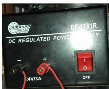
Εικόνα 8.10: Εξωτερικό τροφοδοτικό για τη λειτουργία του συστήματος FLEXIVA
