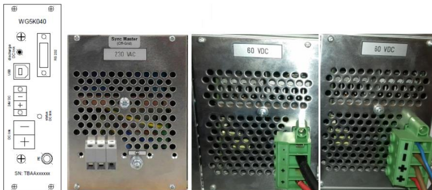
Εικόνα 8.9: Σασί της FLEXIVA (όπισθεν όψη). Οι τρεις μονάδες μετατροπέων και το τμήμα της τροφοδοσίας και επικοινωνίας στα αριστερά
