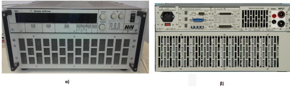
Εικόνα 6.10: Πρόσωση και πίσω όψη ηλεκτρονικού φορτίου ZSAC
