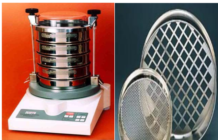
Σχήμα 2.1 Συσκευή κοσκίνισματος και κόσκινα
