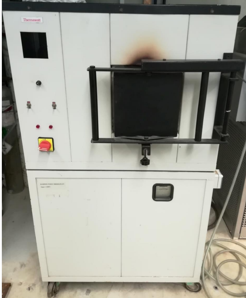
Εικόνα 6.2. Εργαστηριακή κάμινο αντίστασης Εργ. Μεταλλουργίας ΕΜΠ
