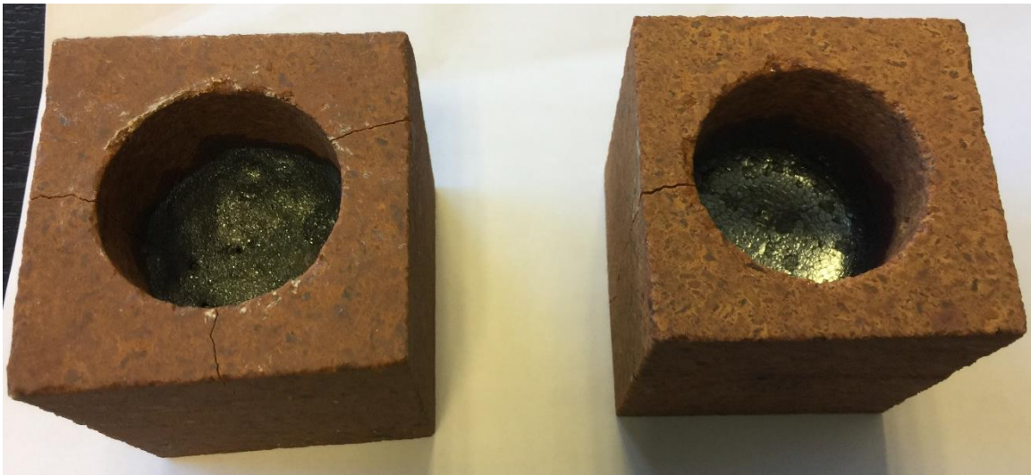
Εικόνα 6.3. Πυρίμαχα μετά τις εργαστηριακές δοκιμές 1 (1600°C, αριστερά) και 4 (1650°C, δεξιά)
