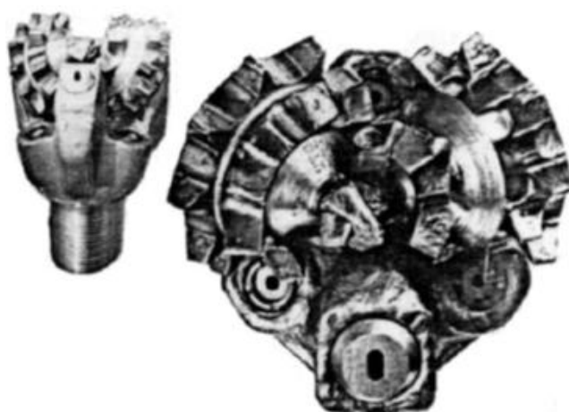
Εικόνα 1.22 : Κοπτικά με ειδικά διαμορφωμένα ακροφύσια σε προσανατολισμό και μέγεθος
