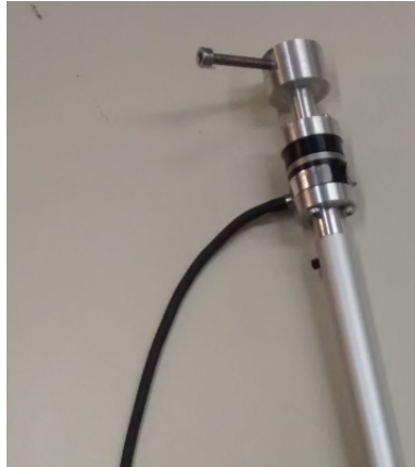
Σχήμα 6.6: Αισθητήρας δυνάμεων/ροπών προσδεμένος πάνω στην δοκό σύζευξης.
