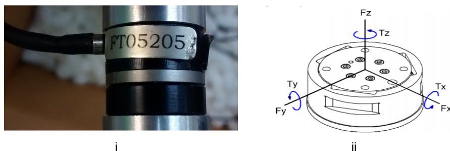
Σχήμα 3.21: Ο αισθητήρας ATI Nano17: i Φωτογραφία ii Σχηματική αναπαράσταση με τους β.ε.
