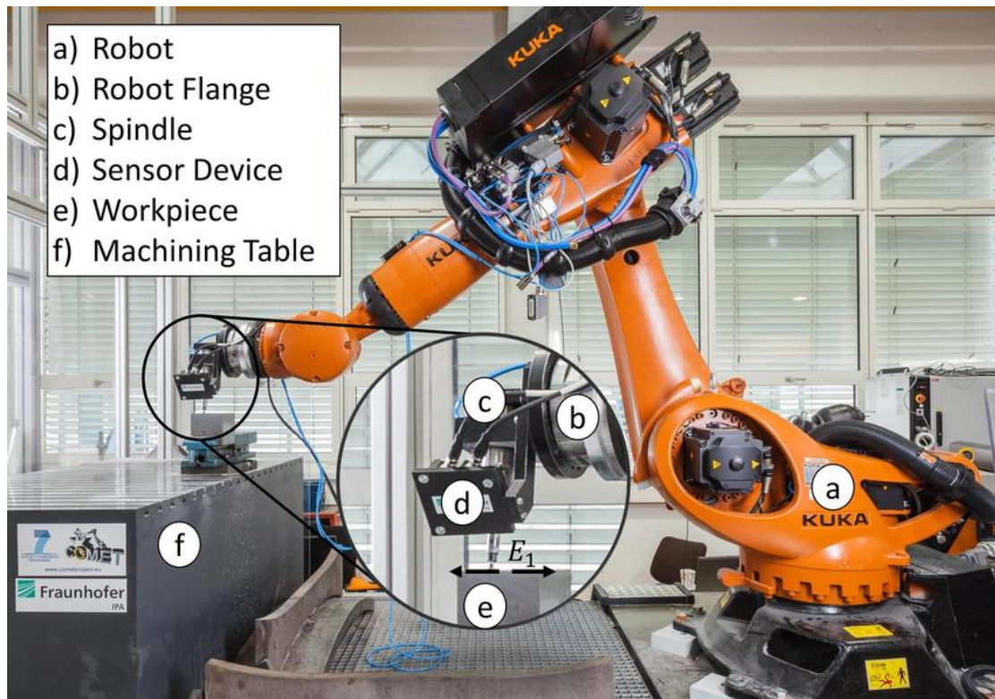
Σχήμα 3-1. Χαρακτηριστικό παράδειγμα εργασίας που απαιτείται έλεγχος δύναμης - λείανση επιφάνειας τεμαχίου.
