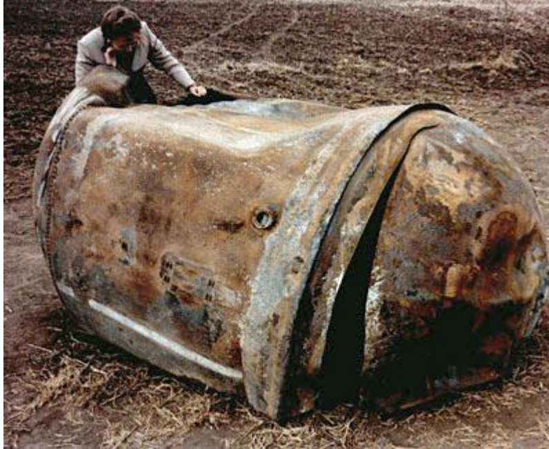
Σχήμα 1-1. Κύρια δεξαμενή προωθητικού αερίου του οχήματος εκτόξευσης Delta 2, που προσγειώθηκε στο Georgetown του Texas.
