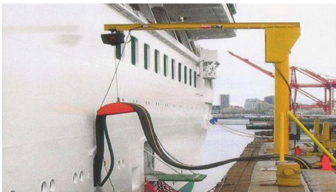
Σχήμα 2.1. Πλοίο κατά την διάρκεια τροφοδότησης των ενεργειακών του αναγκών από την ξηρά
