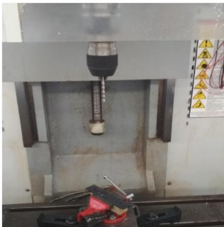
Εικόνα 4.8: Διάταξη διάτρησης-Τρυπάνι, δοκίμιο συγκρατημένο από μέγγενη και μετρητική πλάκα [40]
