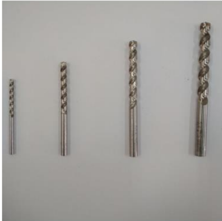
Εικόνα 4.3: Τρυπάνια HSS-Co, από αριστερά προς δεξιά \Phi 2 , \Phi 3 , \Phi 4 , \Phi 5 αντίστοιχα [40]
