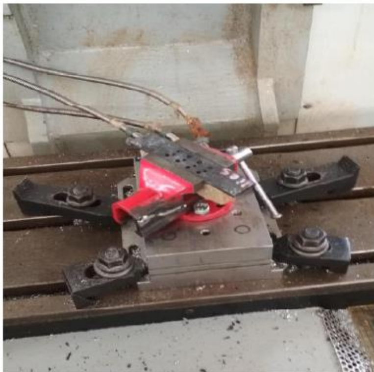
Εικόνα 4.7: Διάταξη συγκράτησης δοκιμίου-μέγγενη [40]
