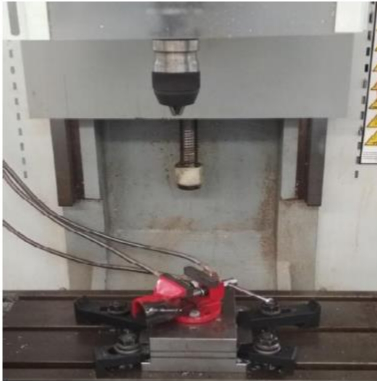
Εικόνα 4.6: Διάταξη συγκράτησης δοκιμίου-μέγγενη-και μετρητική πλάκα συγκρατημένη στην τράπεζα της εργαλειομηχανής [40]
