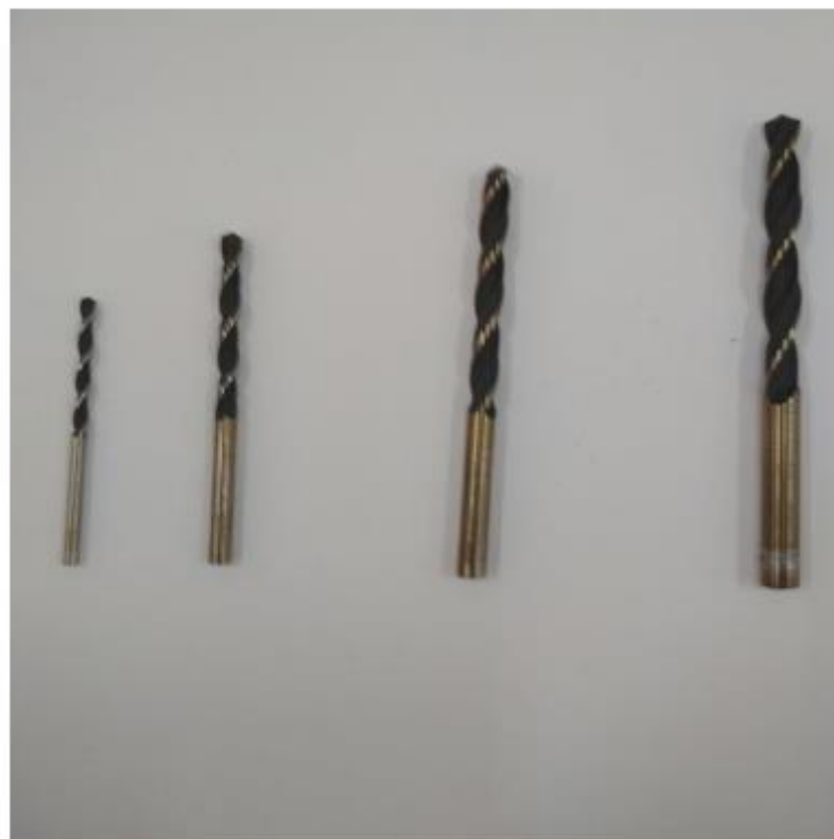
Εικόνα 4.4: Τρυπάνια HSS-CC, από αριστερά προς δεξιά \Phi 2 , \Phi 3 , \Phi 4 , \Phi 5 αντίστοιχα [40]
