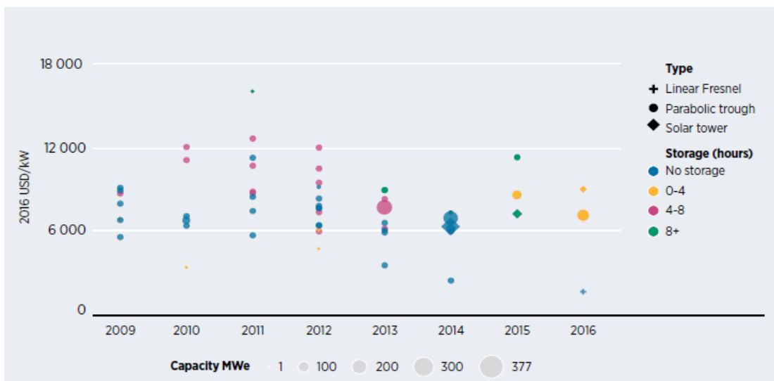
Εικόνα 7 Εγκατεστημένο κόστος κατά μέγεθος έργου τύπου συλλέκτη και ποσότητα αποθήκευσης 2009-2016
