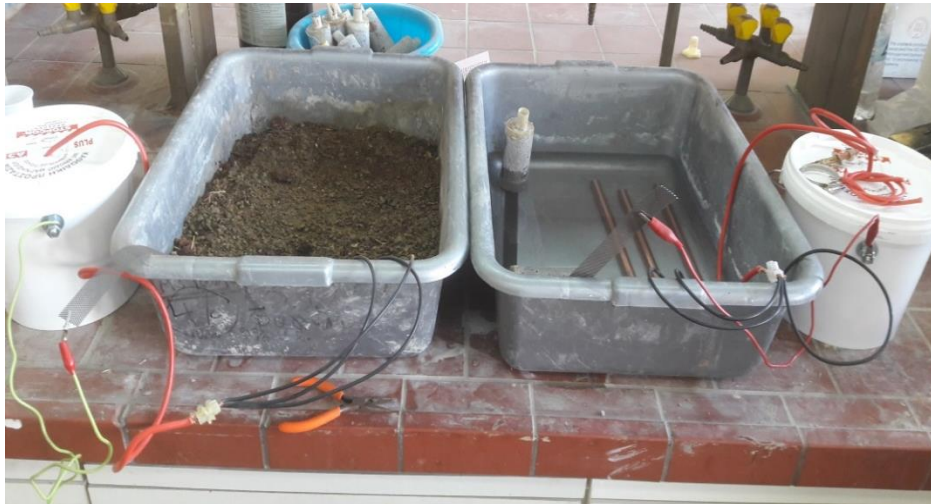
Εικόνα 64 : Εφαρμογή καθοδικής προστασίας στο έδαφος και νερό.
