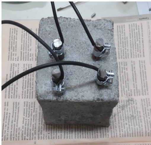
Εικόνα 49 : Εφαρμογή καλωδίων και ρητίνης για την ολοκλήρωση της καθοδικής προστασίας.
