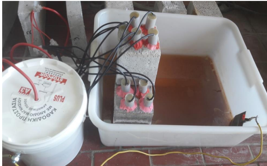
Εικόνα 53 : Αστοχία ανόδου από ανοξείδωτο χάλυβα μετά το πέρας μιας εβδομάδας.
