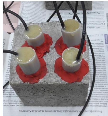
Εικόνα 49 : Εφαρμογή καλωδίων και ρητίνης για την ολοκλήρωση της καθοδικής προστασίας.
