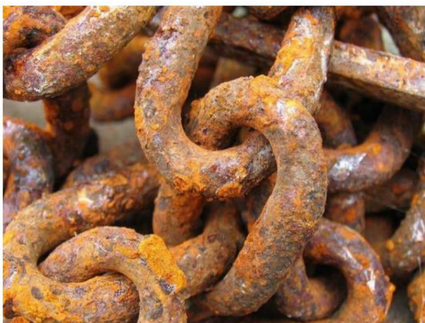
Εικόνα 1 : Φαινόμενο διάβρωσης σε μέταλλο (αλυσίδα άγκυρας)
