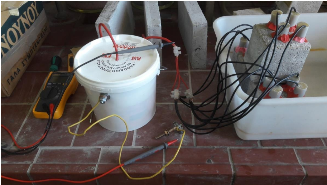
Εικόνα 51 : Εφαρμογή της καθοδικής προστασίας και χρήση ποτενσιόμετρου.
