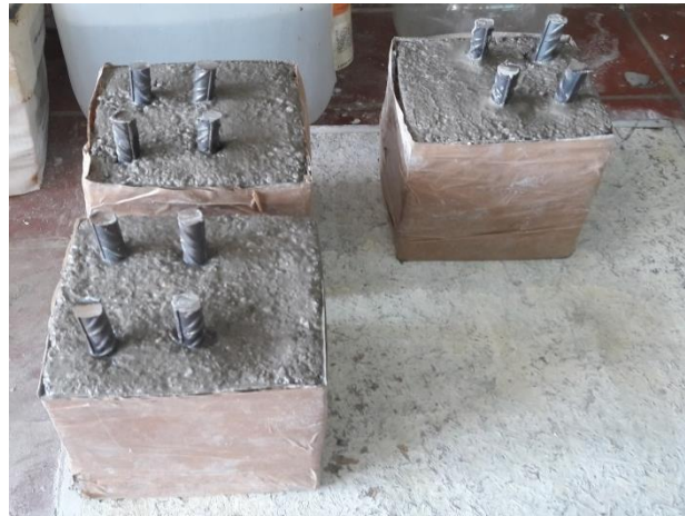
Εικόνα 48 : Δημιουργία του σπλισμένου σκυροδέματος.
