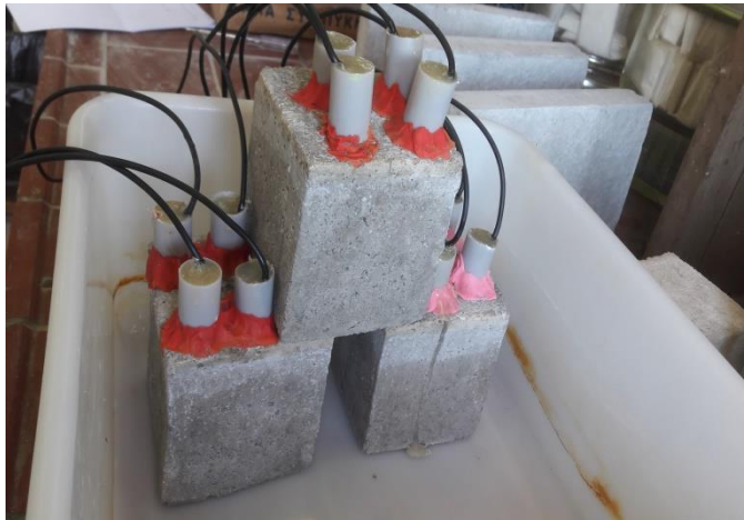
Εικόνα 50 : Διάταξη των δοκιμίων σε νερό (3,5% NaCl) και αέρα.
