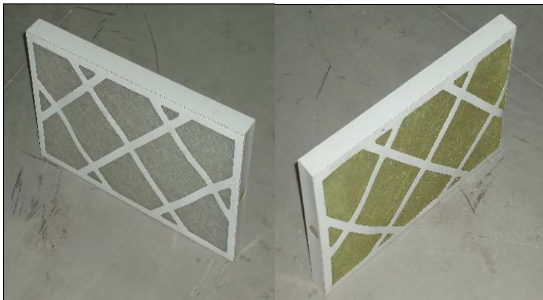
Σχήμα 3.12: Όψεις πρόφιλτρου αφυγραντήρα του αέρα επεξεργασίας (Γ.4) και του αέρα αναγέννησης (Γ.7)
