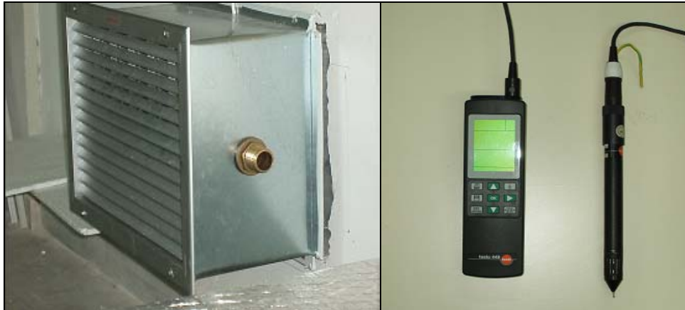
Σχήμα 3.14: Στην αριστερή εικόνα είναι η οπή του στομίου που μετράμε την ταχύτητα και στην δεξιά εικόνα είναι το ταχύμετρο
