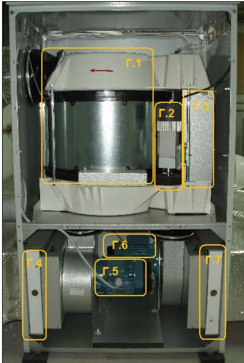
Σχήμα 3.13: Εσωτερική διάταξη αφυγραντήρα, (Γ.1) Ρότορας, (Γ.2) Μοτέρ κίνησης (mini motor ACE 66T), (Γ.3) Δύο αντιστάσεις θέρμανσης, (Γ.4) Φίλτρο του αέρα προς επεξεργασία, (Γ.5) Κινητήρας φυσητήρα του αέρα προς επεξεργασία (ABB motors), (Γ.6) Κινητήρας φυσητήρα του αέρα αναγέννησης (ABB motors), (Γ.7) Φίλτρο του αέρα αναγέννησης
