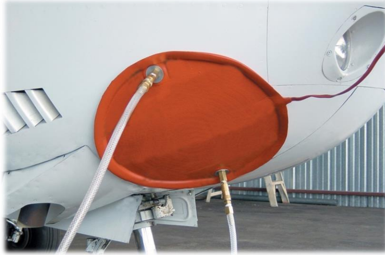
Εικόνα 4.17 Composite curing heating blanket with vacuum seal
