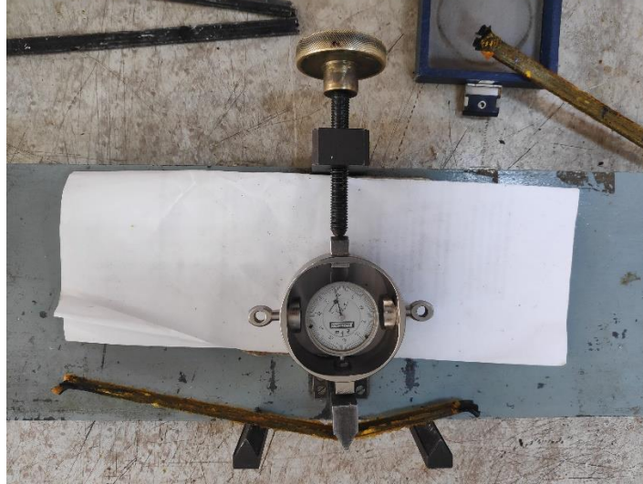
Εικόνα 6.23 Διάταξη δοκιμής σε κάμψη
