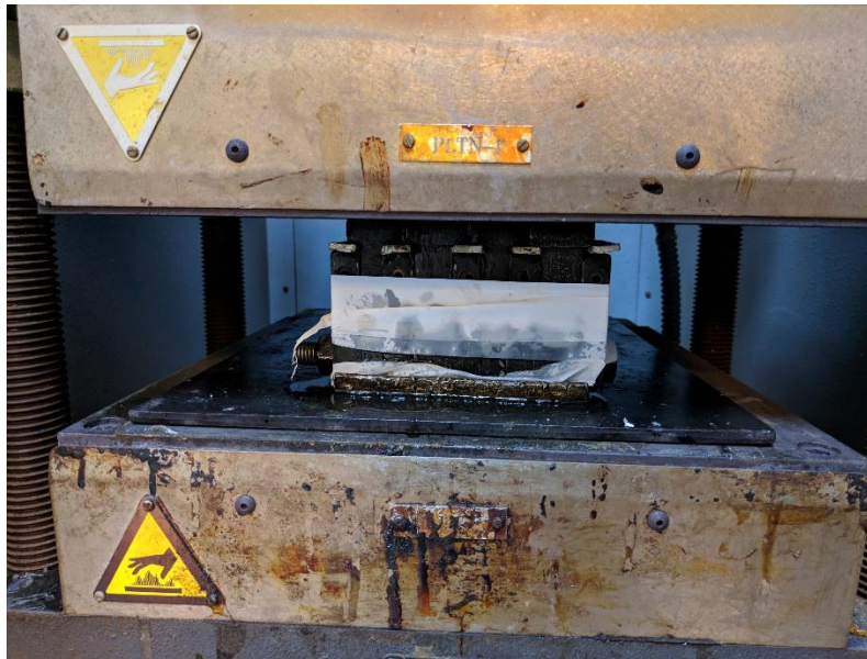
Εικόνα 6.17 Καλούπι στην θερμοπρέσα δεμένο με ταινία teflon
