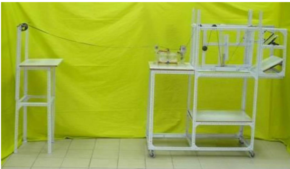
Εικόνα 6.9 Εργαστηριακή διάταξη προδιαπότισης ινών
