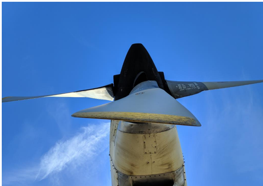
Εικόνα 4.1 Έλικα της Hamilton Standard 54H60 σε C-130, το front spinner κατασκευάζεται από σύνθετο υλικό πολυμερικής μήτρας με ενίσχυση ίνας υαλού.
