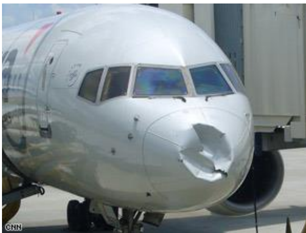
Εικόνα 4.25 Radome το οποίο χρήζει επισκευής
