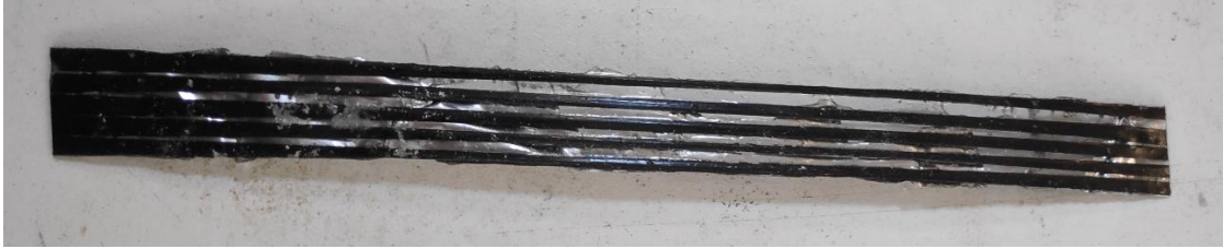
Εικόνα 6.16 Στρώση από πέντε ίνες άνθρακα προδιαποτισμένες με εποξειδική ρητίνη και σκληρυντή
