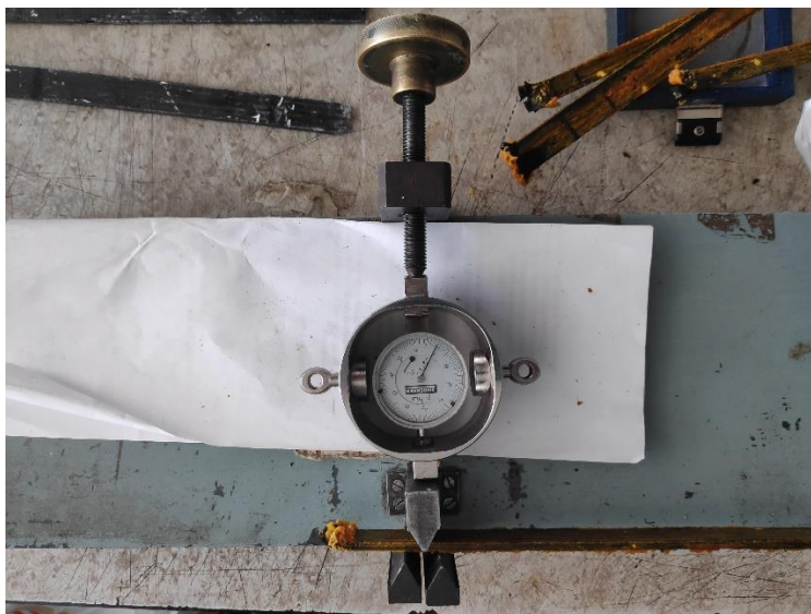
Εικόνα 6.24 Διάταξη δοκιμής σε διάτμηση
