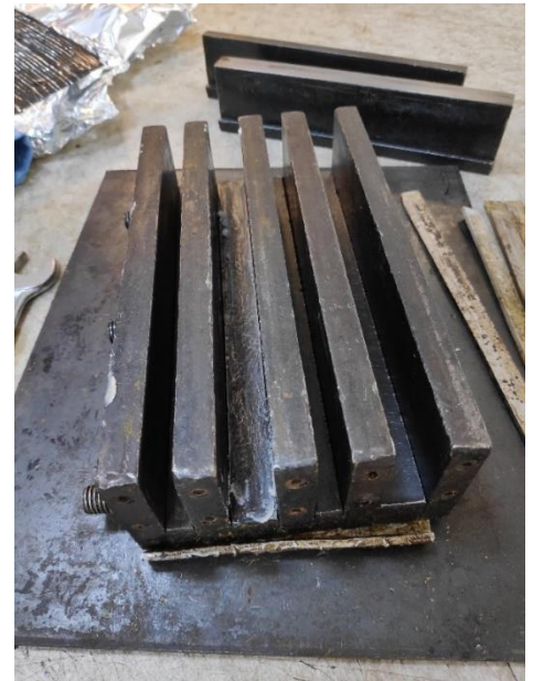
Εικόνα 6.10 Μεταλλικό καλούπι μορφοποίησης σύνθετου υλικού
