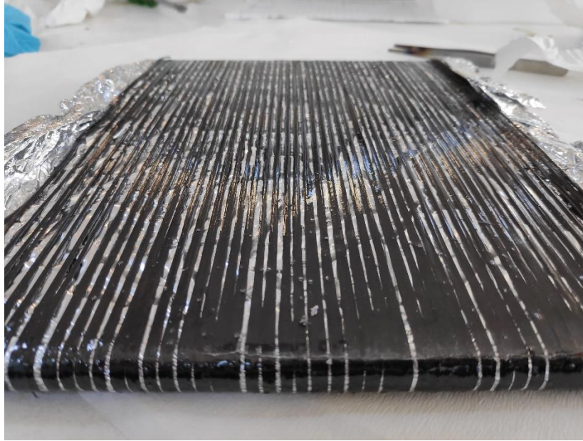
Εικόνα 6.15 Προδιαποτισμένες ίνες άνθρακα με εποξειδική ρητίνη, περιτυλιγμένες στην πλάκα
