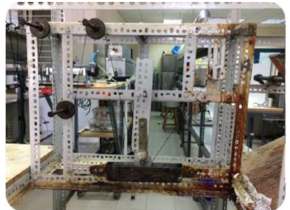
Εικόνα 6.7 Εργαστηριακή διάταξη προδιαπότισης ινών
