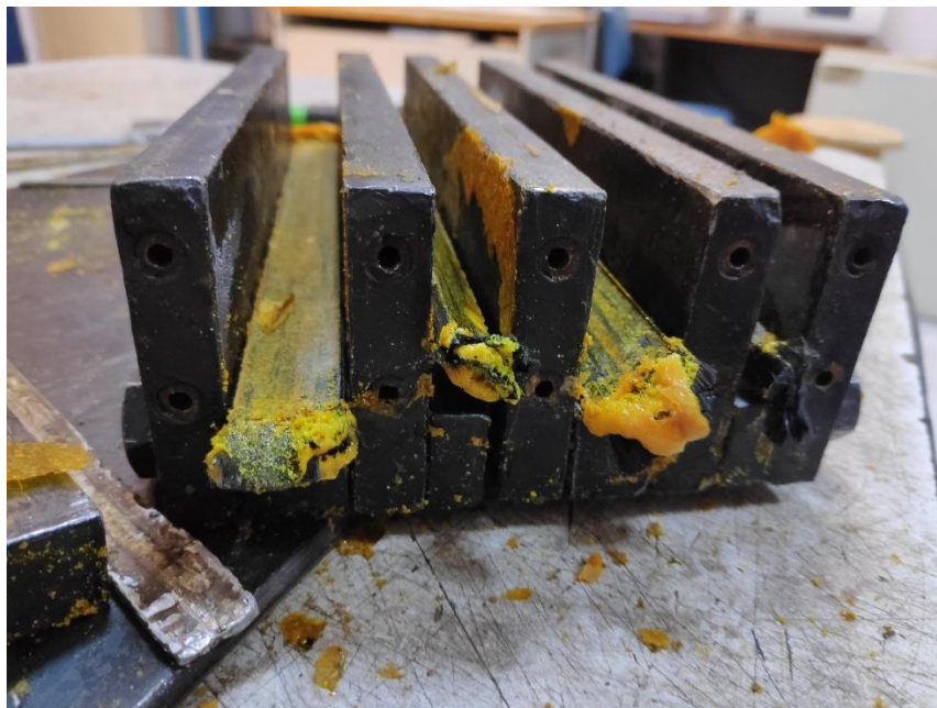
Εικόνα 6.14 Ανοικτό καλούπι, με εμφανή τα δοκίμια
