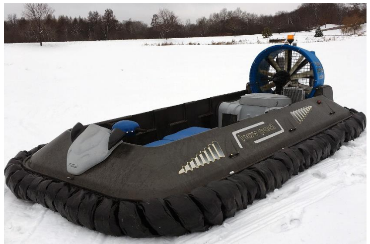
Σικόνα 4.34 Τα Hov Pod Hovercrafts κατασκευάζονται από HDPE (High Density Polyethylene) με ίνες άνθρακα ή Kevlar ή γυαλιού
