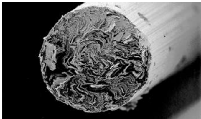
Εικόνα 3.8 Δομή ίνας άνθρακα υψηλού μέτρου ελαστικότητας
