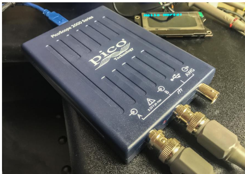
Σχήμα 5-2. Φωτογραφία του ψηφιακού παλμογράφου που χρησιμοποιήθηκε στην πειραματική διάταξη για πρόσθετη ακρίβεια στις μετρήσεις πέρα από τη χρήση του αναλογικο-ψηφιακού μετατροπέα του μικροεπεξεργαστή Arduino Due.
