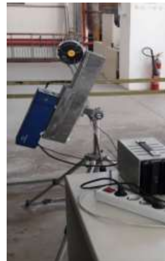
Σχήμα 3.8 Διάταξη δεξαμενής και συσκευής ακτίνας laser.
