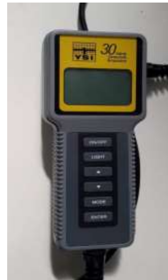
Σχήμα 3.7 Αριστερά: Προβολέας συγκεντρωτικής δέσμης. Δεξιά: Όργανο μέτρησης αλατότητας (YSI 30)
