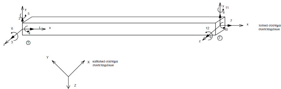
Σχήμα 3.3 Στοιχείο δοκού στο χώρο (12 βαθμοί ελευθερίας)
