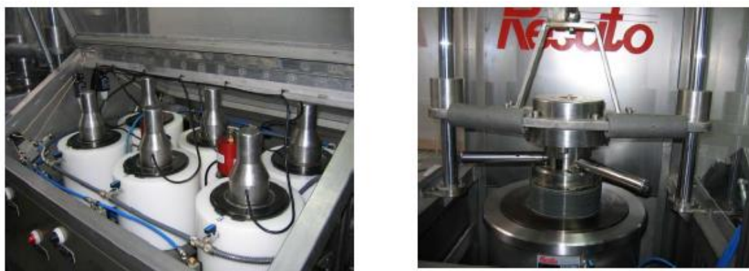
Εικόνα 19 Λεπτομερής άποψη της μονάδας. Αριστερά: Τα 6 κελιά της ΥΠ των 42 mL το καθένα και Δεξιά: θάλαμος επεξεργασίας τροφίμων όγκου 1,5 L
