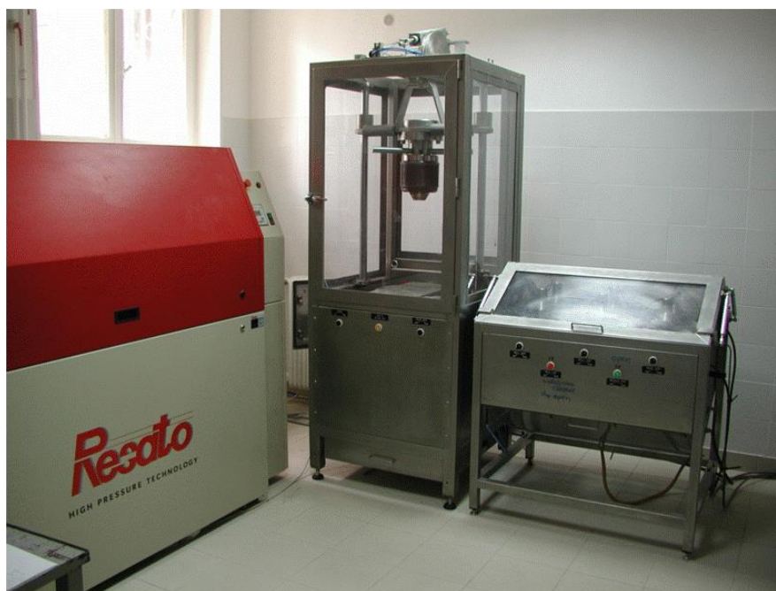
Εικόνα 18 Γενική άποψη του εργαστηρίου Υπερυψηλής Πίεσης και της μονάδας ΥΠ. Στο κέντρο διακρίνεται η μονάδα για την επεξεργασία τροφίμων όγκου 1,5 L και στα δεξιά η μονάδα με τα 6 δοχεία ΥΠ των 42 mL το καθένα
