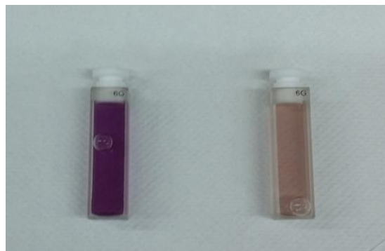
Εικόνα 22 Ελεύθερη ρίζα DPPH (αριστερά), διάλυμα DPPH πριν την αντιδραση με αντιοξειδωτικό (μωβ χρώμα) και μετά (αποχρωματισμένο)(δεξιά)
